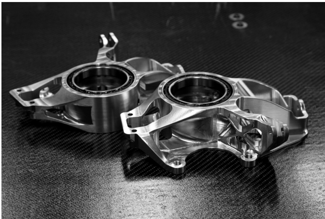
Obrázek 3 Obráběné těhlice týmu UVic Formula Racing [4]
