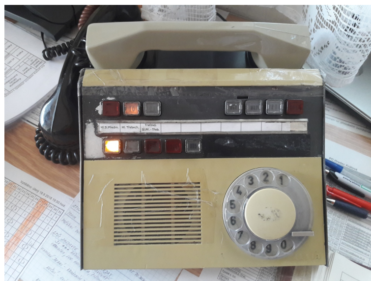
Obrázek 11: Traťový telefon na hlásce, zdroj: [49]
