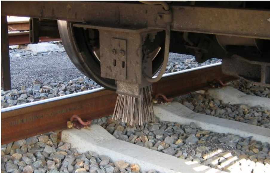
Obrázek 15: Kontakt bodového zabezpečovače na vozidle, zdroj: [53]
