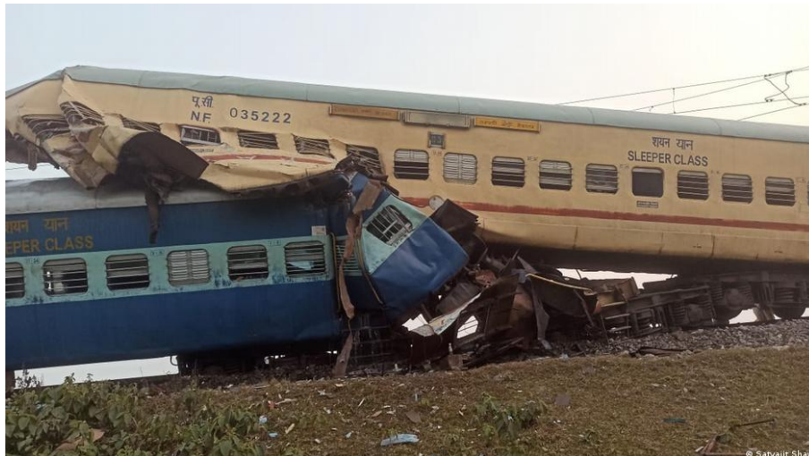
Obrázek 2: Příklad šplhání železničních vozů po nehodě, zdroj: [41]
