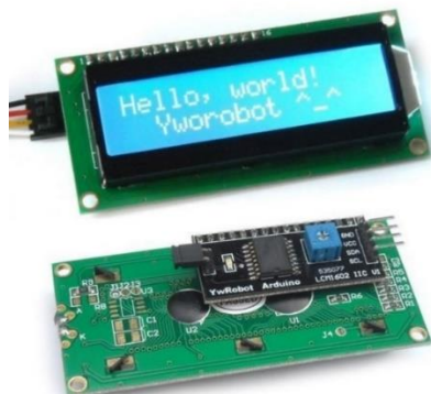
Obr. 2.8 – LCD Displej 16x2 znaky [16]
