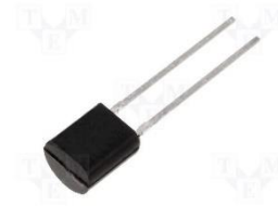
Obr. 2.10 - Senzor teploty KTY81-110 [18]
