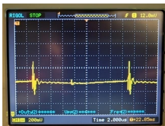
Obr. 4.2 - PWM 62 500Hz. Pri vyššom rozlíšení sú vidieť napäťové špičky vyvolané zmenou elektromagnetickej indukcie na cievke pri spínaní MOSFETu.
