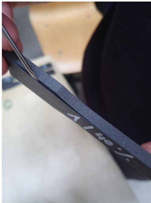
Obrázek 3-9 znázornění poškození vzorku 5/40
