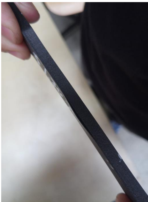
Obrázek 3-7 zobrazení poruchy vzorku 5/70
