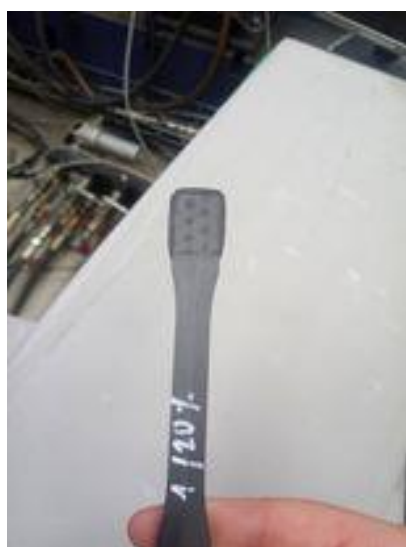
Obrázek 3-13 poškození vzorků 1 při upnutí do hydraulických kleští
