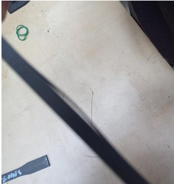
Obrázek 3-10 zobrazení poškození vzorku 2/40
