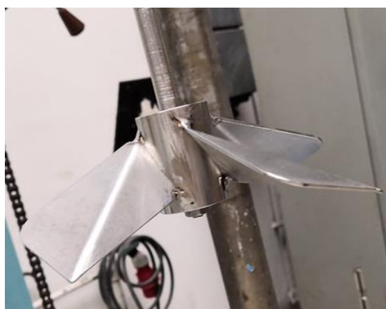
Obrázek 36-Použité čtyřlopatkové míchadlo s rovnými lomenými lopatkami 2
