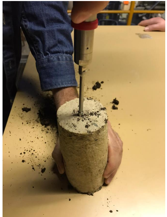
Obrázek 48- Měření tlaku k proražení dna kelímku pomocí ručního penetrometru
