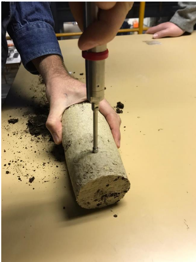
Obrázek 47- Měření tlaku k proražení stěny kelímku pomocí ručního penetrometru
