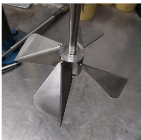
Obrázek 35-Použité čtyřlopatkové míchadlo rovnými lomenými lopatkami 1
