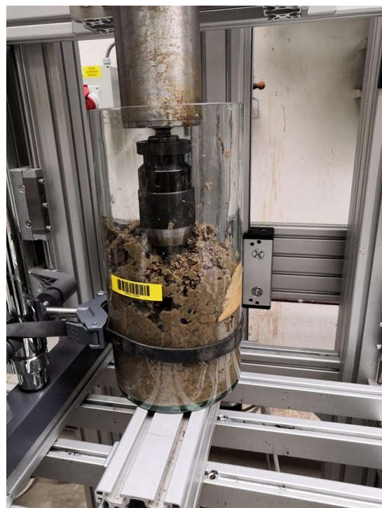
Obrázek 53- Měření 10% hm. kartonu s tvorbou vzduchových kapes
