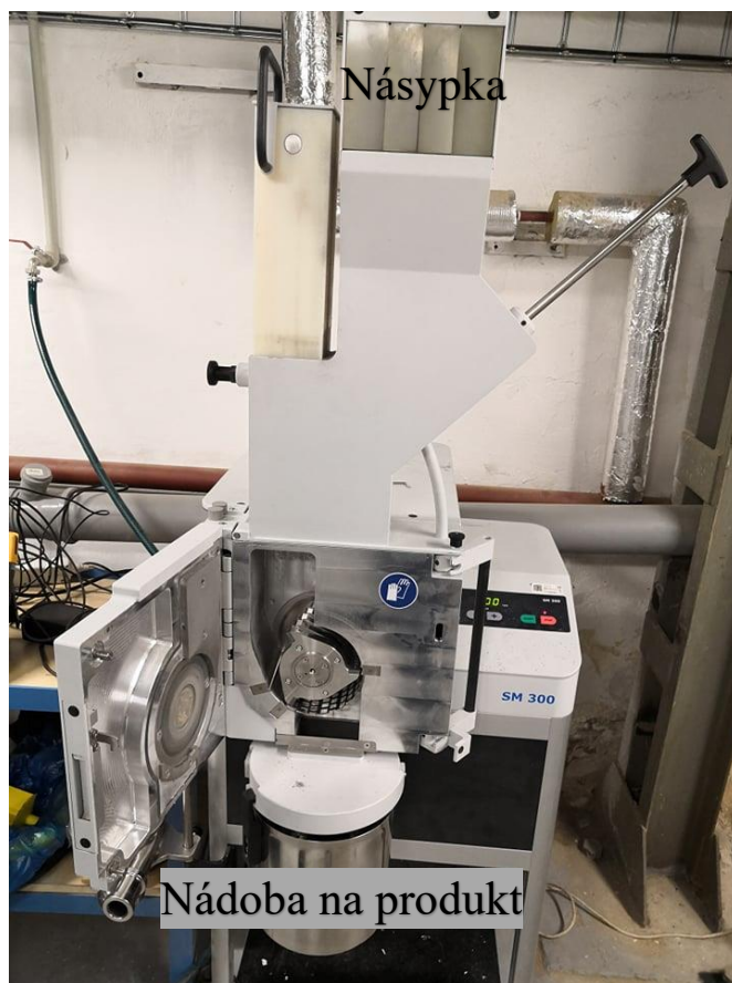
Obrázek 32- Střížný mlýn SM 300
