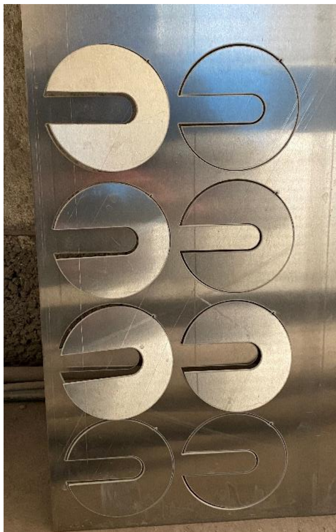
Obrázek 10 - Speciální podložky a díly na formy pro výrobu cihel [vlastní]
