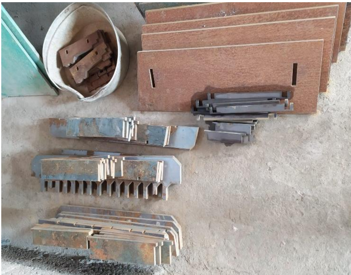
Obrázek 9 - Speciální podložky a díly na formy pro výrobu cihel [vlastní]
