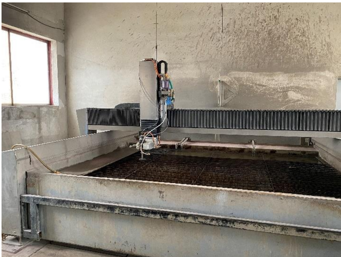
Obrázek 8 – Pětiosý řezací stroj [vlastní]
