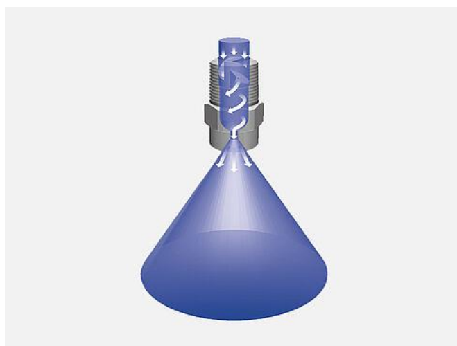
Obr. 26: Axiální tryska s rozstřikem plného kužele [31]
