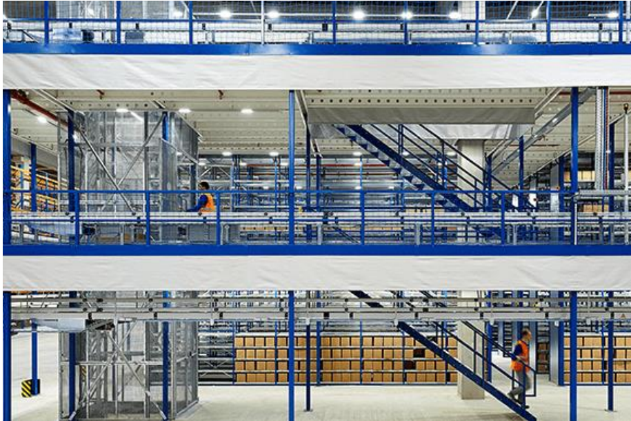
Obrázek 4: Mezaninová konstrukce pater skladu [31]
