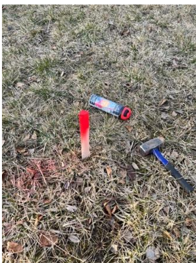
Obr. 30 – Dočasně stabilizovaný bod
