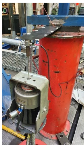
Obrázek 16 Detail upnutí budiče bez kleštinky
