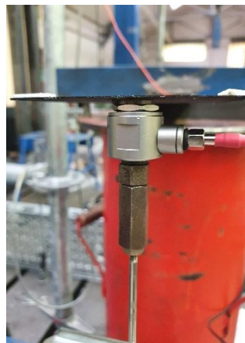
Obrázek 17 Detail upnutí budiče bez kleštinky
