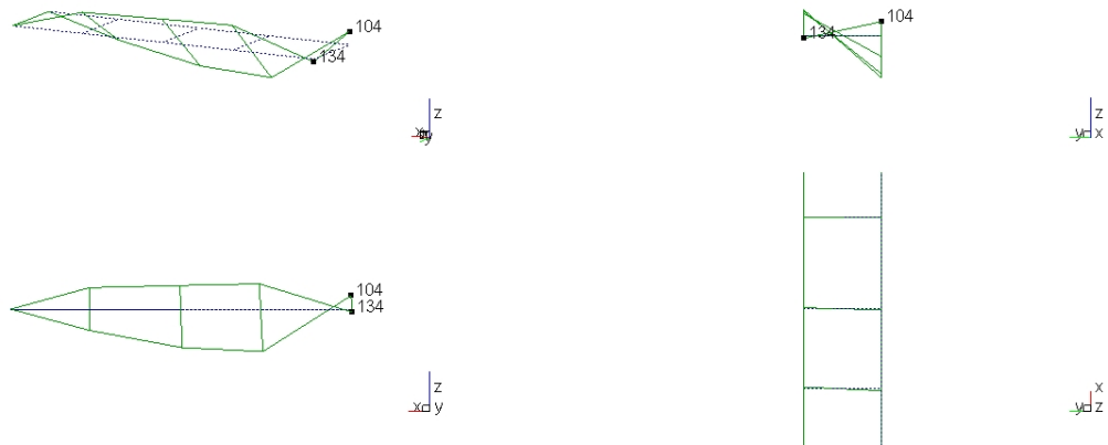
Obrázek 38 Tvar 2. torzního módu při měření torze se dvěma budiči
