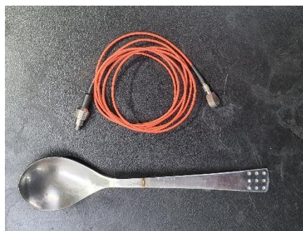
Obrázek 25 Porovnání velikosti akcelerometru 4517 proti kávové lžičce
