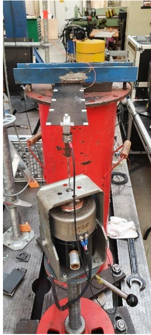
Obrázek 15 Deska V1 připravena na měření s upnutým budičem a akcelerometrem na bodě 101
