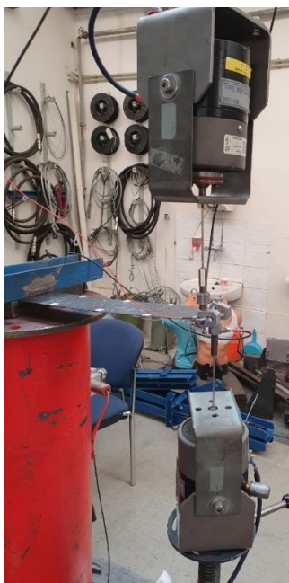
Obrázek 23 Detail uložení dvou budičů
