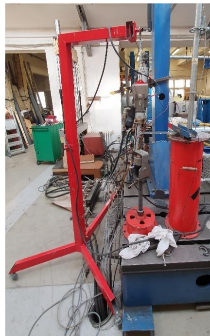
Obrázek 22 Měřicí soustava s deskou v konfiguraci V2 před měřením torze
