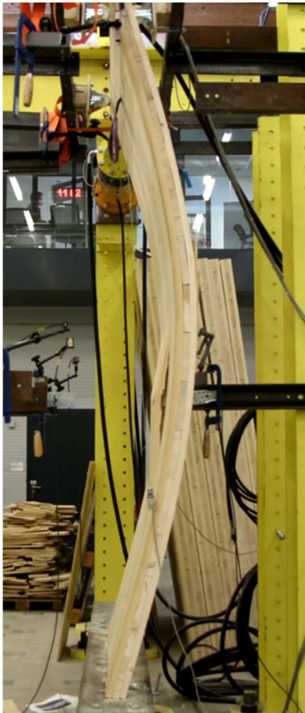
Obr.42 Vlevo maximální dosažená deformace zatíženého vzorku, vpravo vzorek po odlehčení (focen zkušební vzorek 2) (POZN: viditelné poškození podélné lamely v tlačené části panelu je způsobeno proražením panelu ocelovou kotvou, která měla chránit snímače, nejedná se o porušení vlivem vzpěru)
