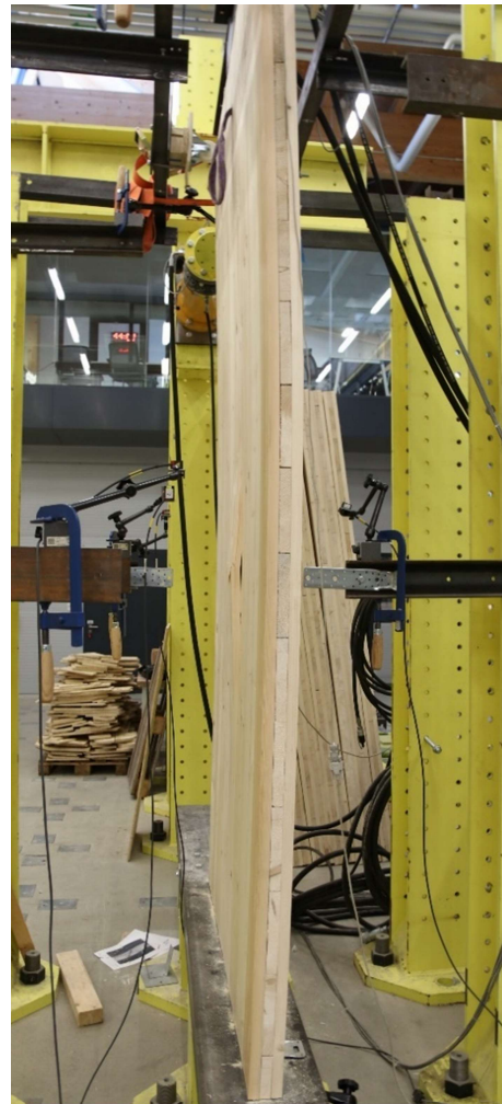
Obr.42 Vlevo maximální dosažená deformace zatíženého vzorku, vpravo vzorek po odlehčení (focen zkušební vzorek 2) (POZN: viditelné poškození podélné lamely v tlačené části panelu je způsobeno proražením panelu ocelovou kotvou, která měla chránit snímače, nejedná se o porušení vlivem vzpěru)
