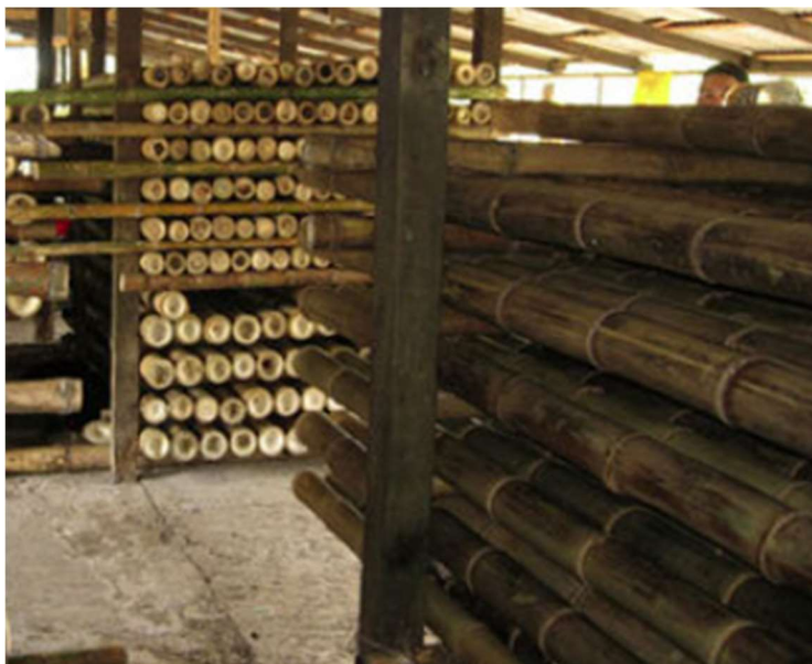
Obrázek 30 Sušení bambusových tyčí na vzduchu
