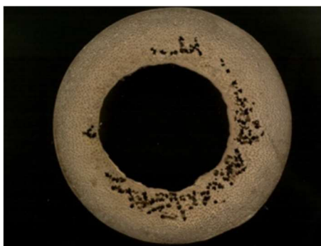
Obrázek 149 Napadení bambusové tyče termity
