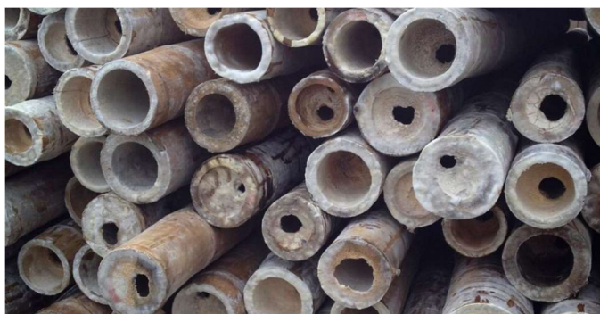
Obrázek 147 Bambusové tyče napadené plísněmi
