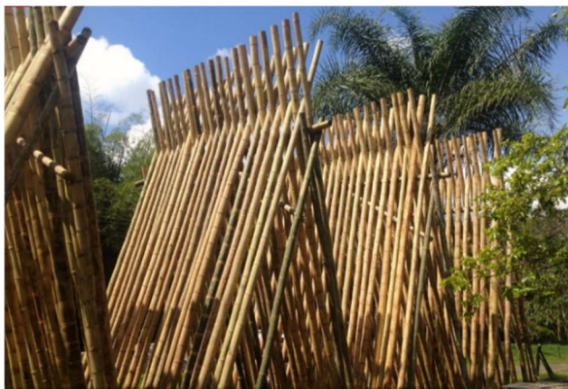
Obrázek 31 Sušení tyčí opřením o sebe
