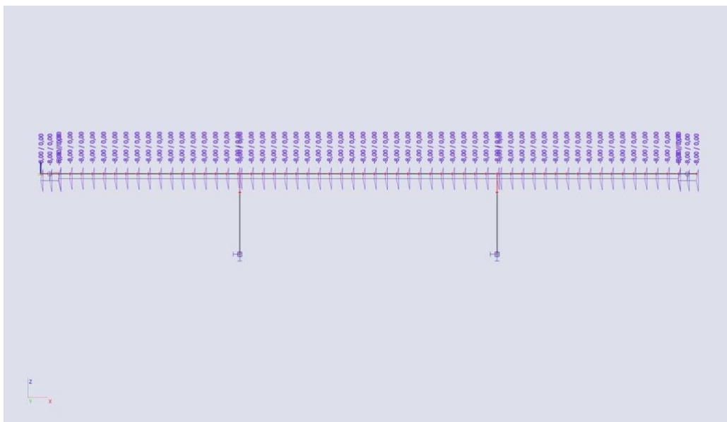
Obrázek 12: Zatížení teplotou – dolní povrch teplejší než horní
