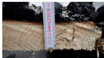
Obr. 60 - zuhelnatění uprostřed stěny
