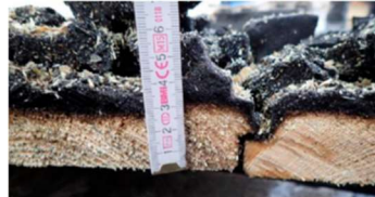
Obr. 61 - zuhelnatění v blízkosti rohu na jedné straně stěny
