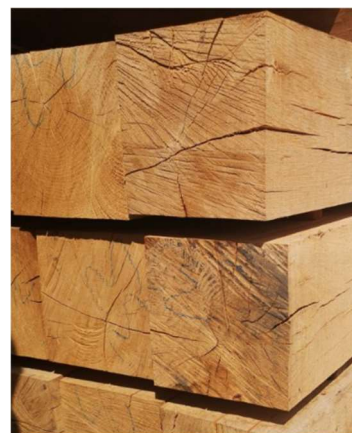
Obr. 6 - masivní rostlé trámy
