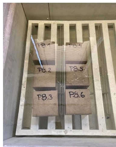
Obrázek 37: Uložení vzorků P8 do vodní nádrže o teplotě 70 °C
