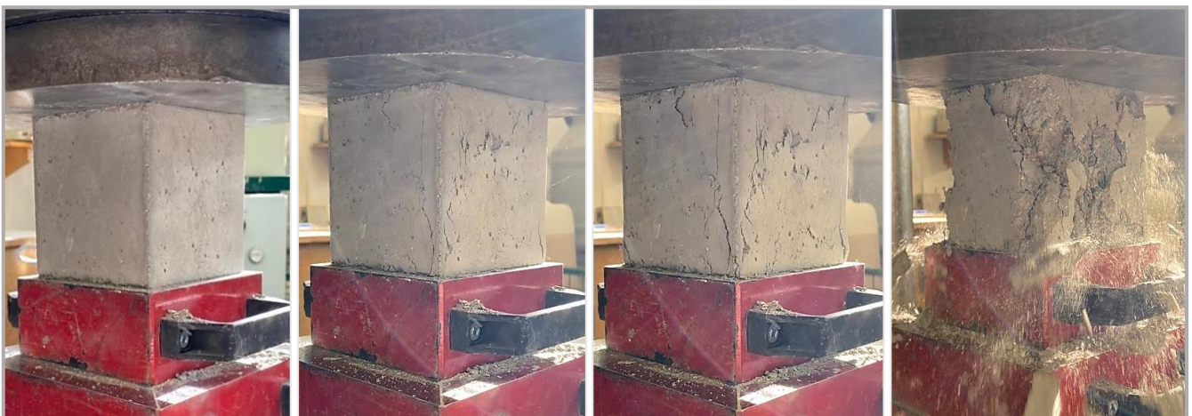
Obrázek 40: Sekvence fotek z průběhu zatěžovací zkoušky
