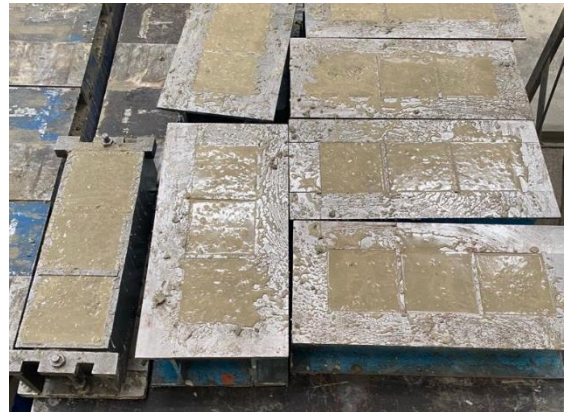
Obrázek 27: Čerstvě zhutněný beton
