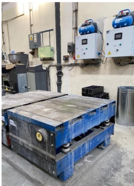
Obrázek 13: Vibrační stůl Standart VTS od společnosti Krejčí engineering, s.r.o
