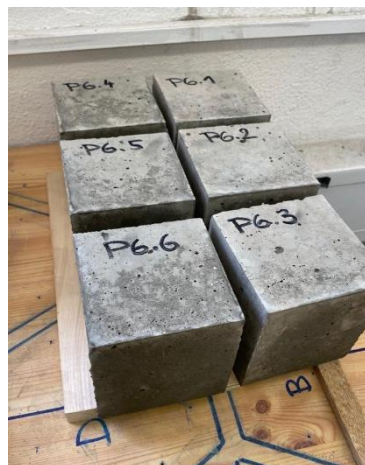
Obrázek 34: Uložení vzorků s urychlovačem P6 v prostředí vzduchu laboratoře
