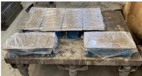
Obrázek 28: Ošetření vzorků fólií po dobu 24 hodin
