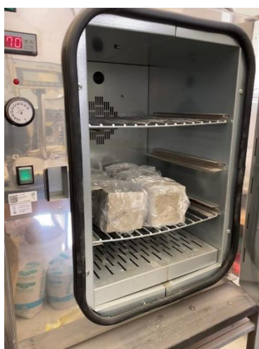
Obrázek 36: Uložení vzorků P7 do sušárny Matest o teplotě 70 °C
