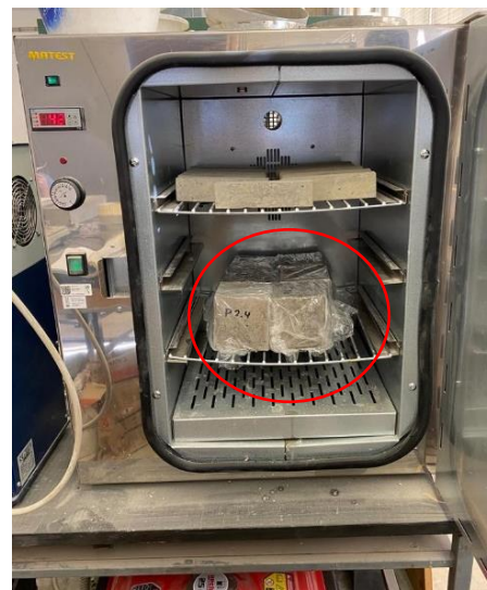
Obrázek 31: uložení vzorků P2 do sušárny Matest při 50 °C
