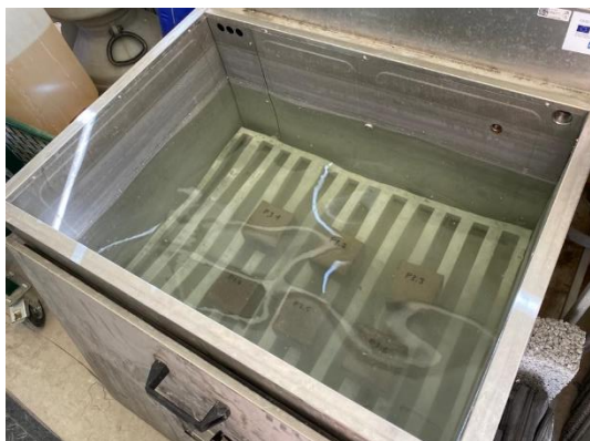
Obrázek 32: Uložení vzorků P3 do vodní nádrže při 50 °C
