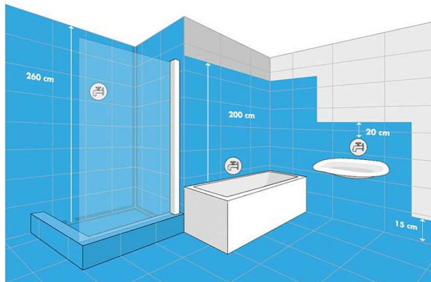
Obrázek 26. Rozsah hydroizolační stěrky v koupelně [71]
