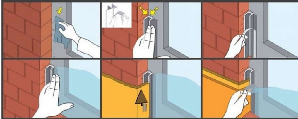
Obrázek 9. Montáž začišťovací lišty [87]
