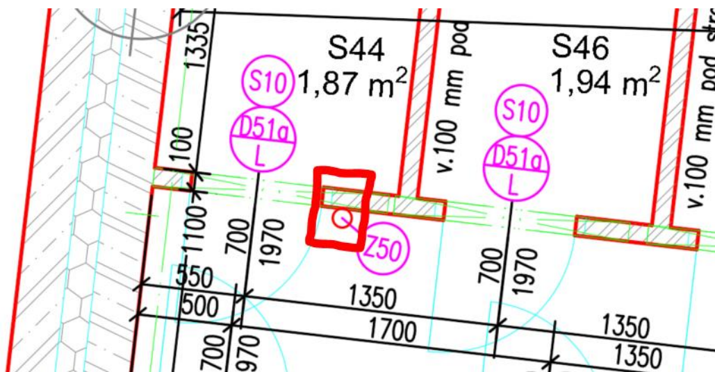
Obrázek 4 – Umístění vývodu uzemnění Z50 vedle sklepní kóje S44
