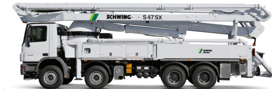
Obr.14 – Autočerpadlo Schwing S 47 SX [10]
