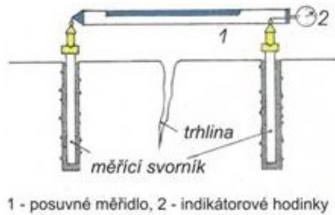
Obrázek 1.5: Trhlinoměr (dilatometr) [9]
