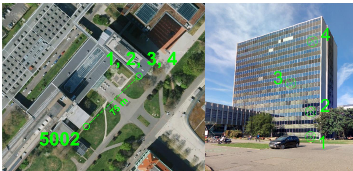
Obr. 22: Situace pro měření zenitových úhlů [19]
