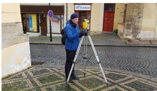
Obrázek 24: Měření totální stanicí
