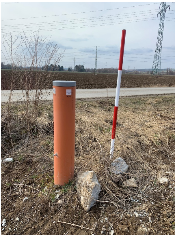
Obr. 13 - Sloupek mikrosítě s observačním stolem
