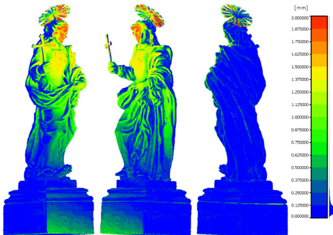
Obr. 4: Porovnání dvou mračen v softwaru CloudCompare, distribuce odchylek na vertikální stupnice vpravo [7]
