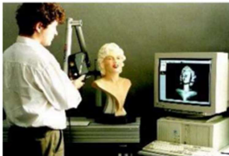
Obr. 13: Ručně ovládaný 3D skener upevněný na ramenu [17]
