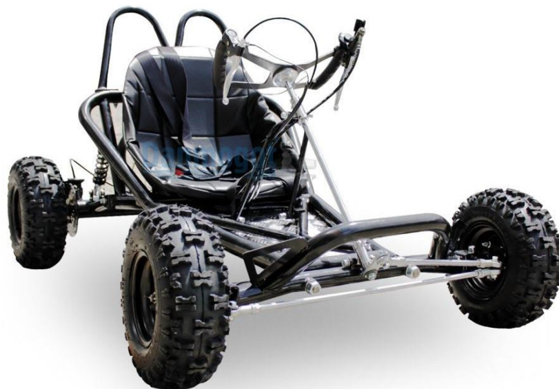
Obr. 30.: Příklad sestavy řízení na motokáře Madman Kart 200cc [24]
