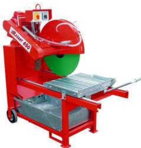
Obrázek 10 - Stolní kotoučová pila na Porotherm
