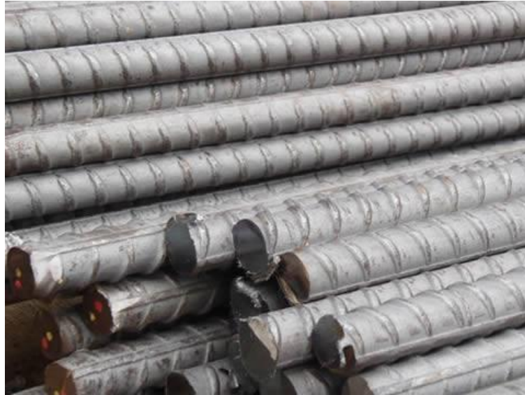
Obr. 3.1 Výztužné pruty opatřené žebírky [17]
