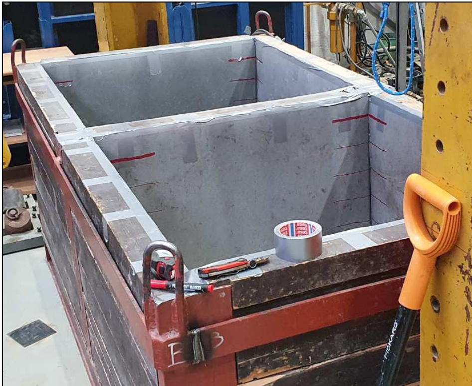
Obr. 25: Laboratorní box upravený pro měření s GPR
