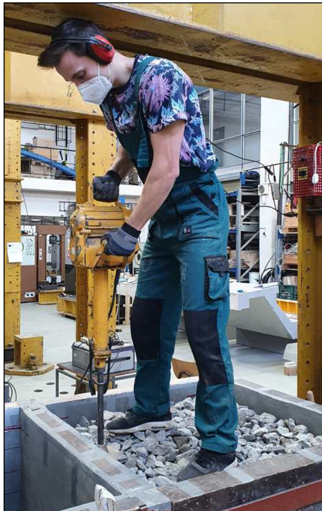
Obr. 31: Model M2-6 a M5-2: Homogenizace kameniva v modelu M5-2 pomocí pěchu
