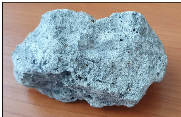
Obr. 2: Zrno umělého kameniva pro kolejové lože
