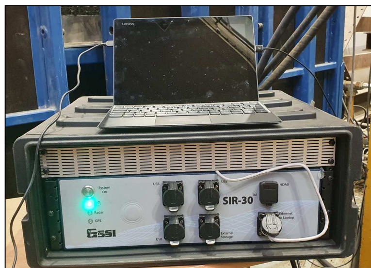
Obr. 26: GPR SIR – 30 s počítačem Lenovo
