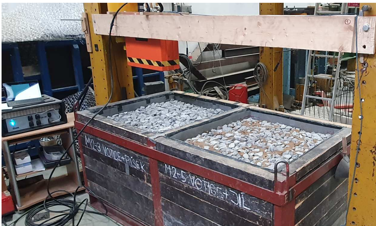
Obr. 35: Model M2-3 a M2-5: Vlevo kamenivo Votice + pískem, vpravo kamenivo Votice + jemnozrná zemina
