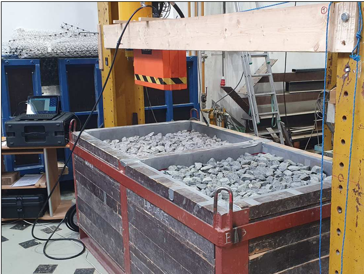
Obr. 29: 7.1.1 Laboratorní model M1-1 s kamenivem Votice (vlevo) a M1-2 s kamenivem Libodřice (vpravo)
