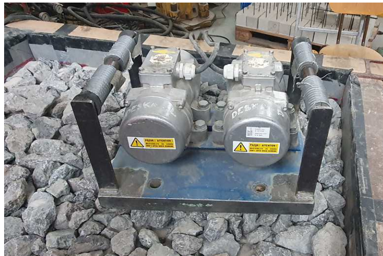
Obr. 34: Příklad pro ruční homogenizaci kameniva z Votic s pískem
