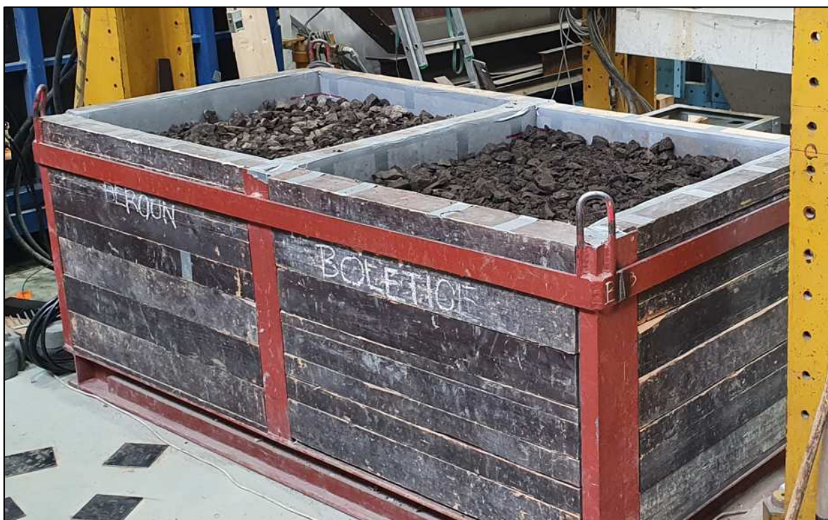
Obr. 30: Model M2-2 a M2-1: vlevo kamenivo Beroun-Závodí, vpravo kamenivo Boletice nad Labem
