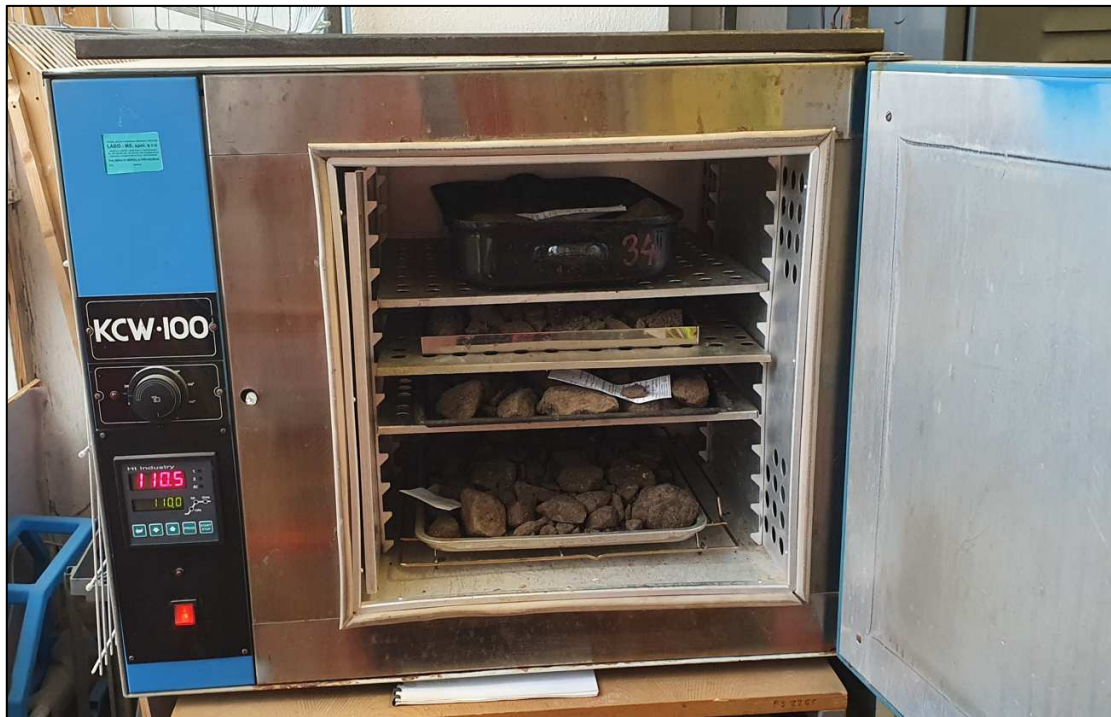
Obr. 36: Sušárna použitá pro stanovení vlhkosti kameniva
