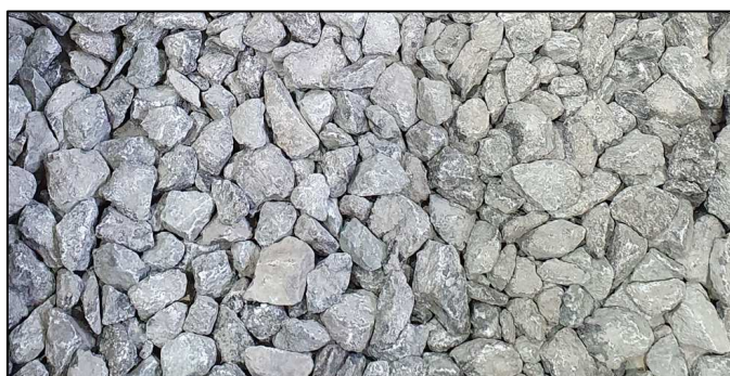
Obr. 1: Přírodní kamenivo pro kolejové lože
