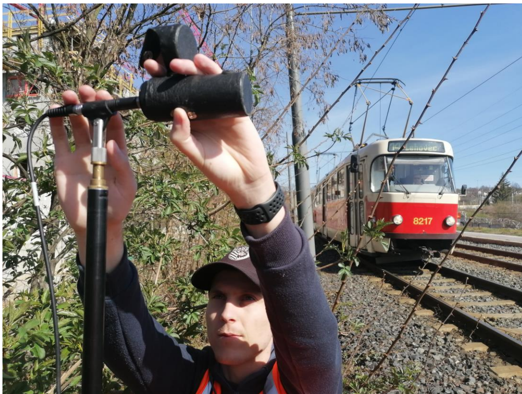
Obrázek 5.18: Ověření mikrofonu pomocí akustického kalibrátoru
