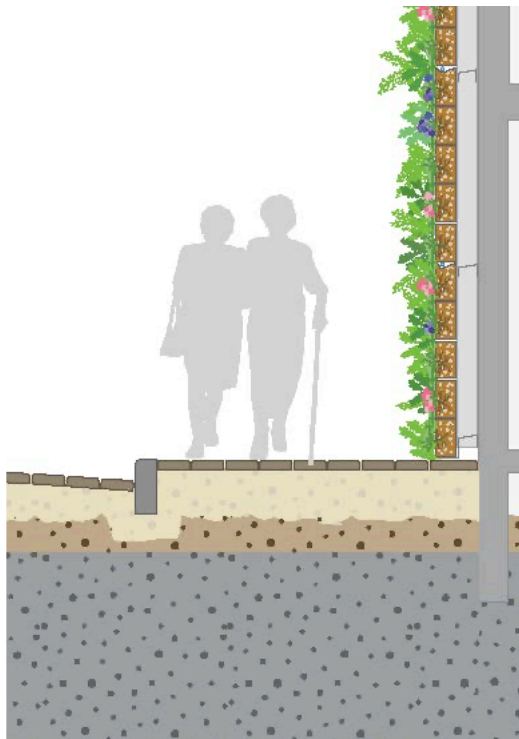
Obr.14: nosné konstrukce pro zavěšení modulových boxů/truhlíků [21]
