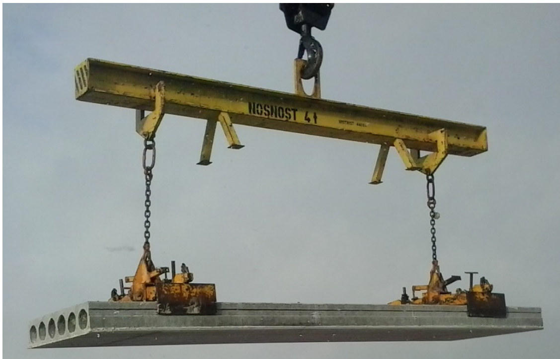
Obr. 3.1.12 – vahadla s manipulačními kleštěmi pro manipulaci panelů SPIROLL[23]
