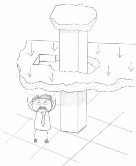
obr. 2.1.1 – protlačení sloupu deskou
