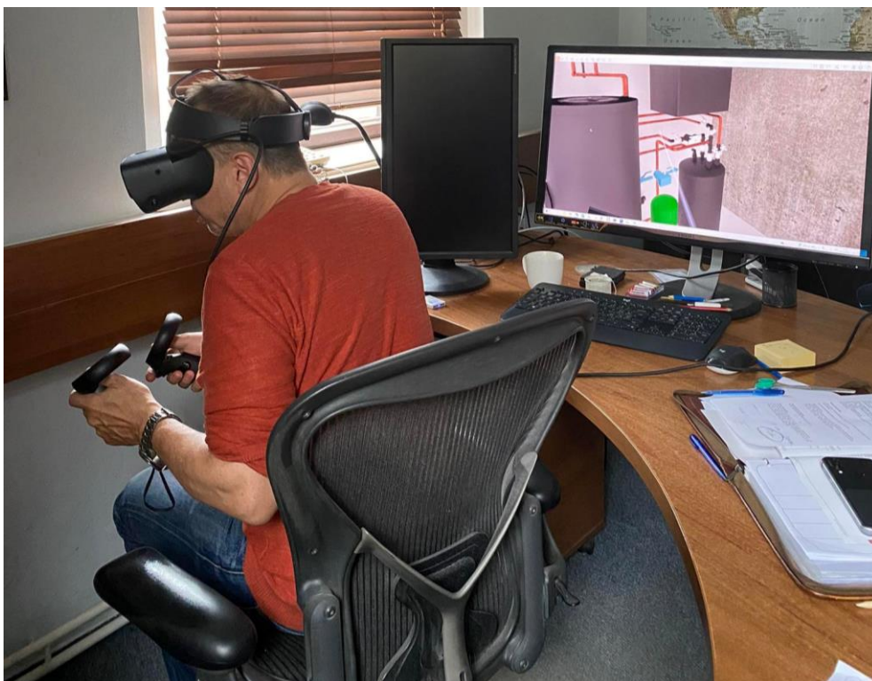
Obrázek č. 14: Zkouška prohlížení projektu strojovny vytápění pomocí VR v kanceláři
