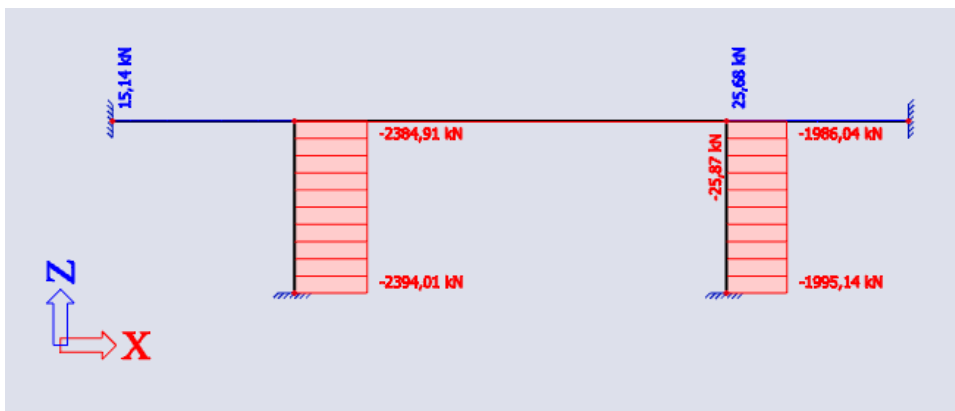
Obr. č. 89 – Vykreslené hodnoty normálových sil na rámu, zatíženém silami z modelu se sníženou tuhostí
