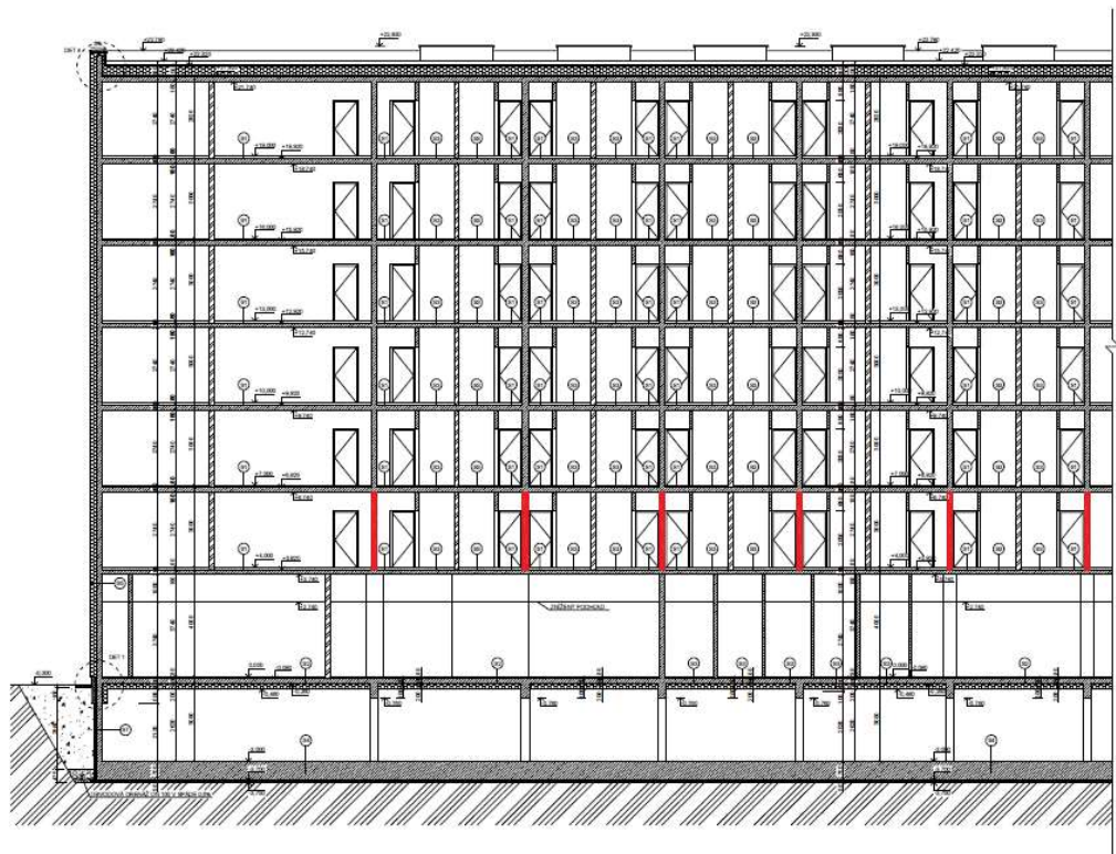
Obrázok 13 – Umiestnenie stenového nosníku v pozdĺžnom reze
