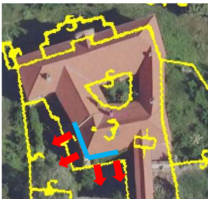
Obrázek 49 - Schéma posunu či pootočení obvodové stěny [6]
