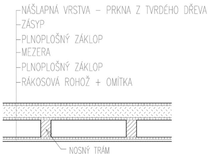
Obrázek 11 - Předpokládaná skladba dřevěného trámového stropu
