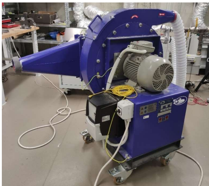
Obrázek 22: Použitý ventilátor pro měření vnitřních netěsností výměníku tepla, zdroj: archiv autora
