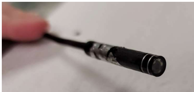
Obrázek 27: Použitý endoskop pro vizuální sledování stavu výměníku tepla, zdroj: archiv autora
