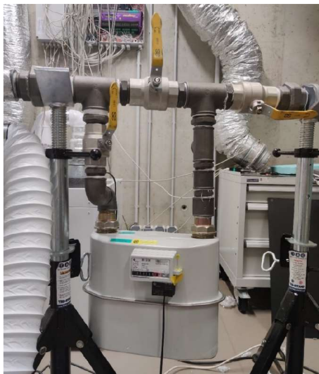
Obrázek 23: Membránový plynoměr použitý pro měření vnitřních netěsností výměníku tepla, zdroj: archiv autora
