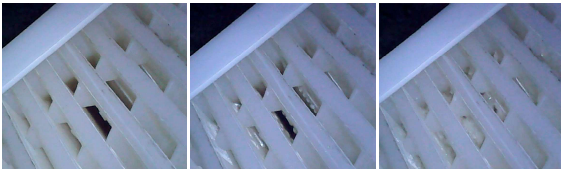
Obrázek 36: Průběh zamrzání měřeného výměníku tepla. Vlevo: počáteční stav, uprostřed: stav po 15 minutách, vpravo: konečný stav. Zdroj: archiv autora
