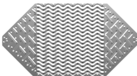
Obrázek 10: Jedna z desek protiproudého výměníku, prostřední část proudí oba proudy vzduchu proti sobě, v okrajových částech kolmo na sebe, zdroj: [20]
