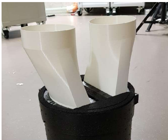
Obrázek 17: Měřený výměník tepla s instalovanými vytištěnými redukcemi, zdroj: archiv autora
