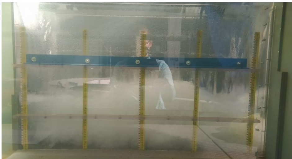
Obr. 97 – Průběh hladiny ve spadišti (výška otevření výpusti 0,06 m) pro průtok 40,7 l/s – výpust i přeliv v provozu
