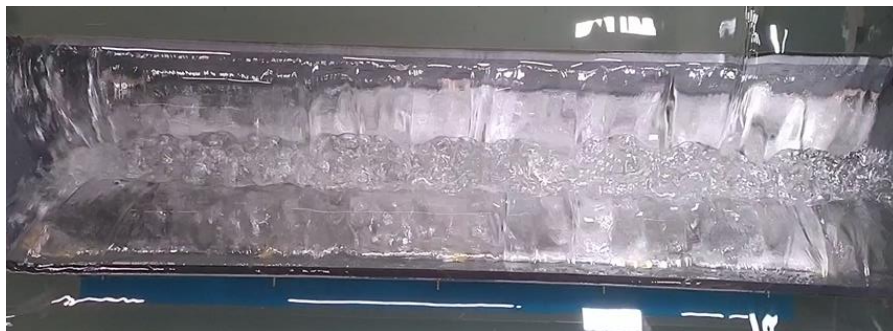
Obr. 68 – Pohled do spadiště pro průtok 69,7 l/s
