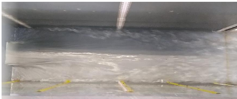
Obr. 87 – Pohled do spadiště (výška otevření výpusti 0,06 m) pro průtok 12,0 l/s – výpust v provozu
