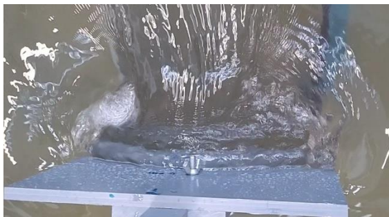
Obr. 93 – Pohled do spadiště ze shora a detail vytvořeného vířů vlivem obtékání čelní stěny spadiště pro zatopený přepad (výška otevření výpusti 0,06 m)
