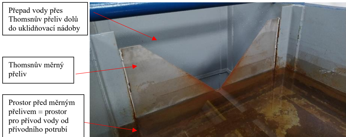
Obr. 52 - Thomsnův měrný přeliv (pro měření průtoku se nepoužíval, prostor součástí uklidňovací nádoby)
