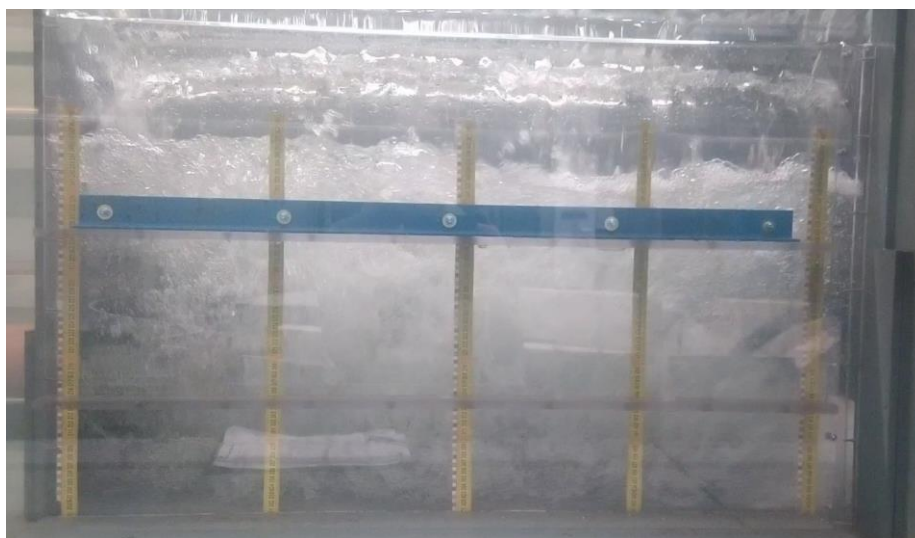
Obr. 76 – Průběh hladiny ve spadišti pro průtok 69,7l/s
