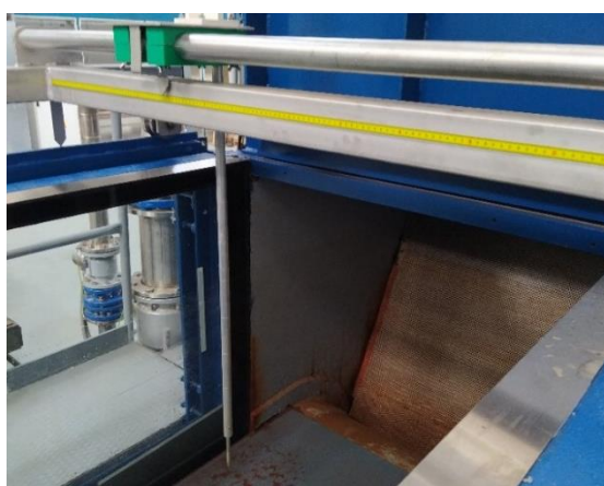
Obr. 50 – Tlumící síto na nátok do laboratorního žlabu, hrotové měřítko
