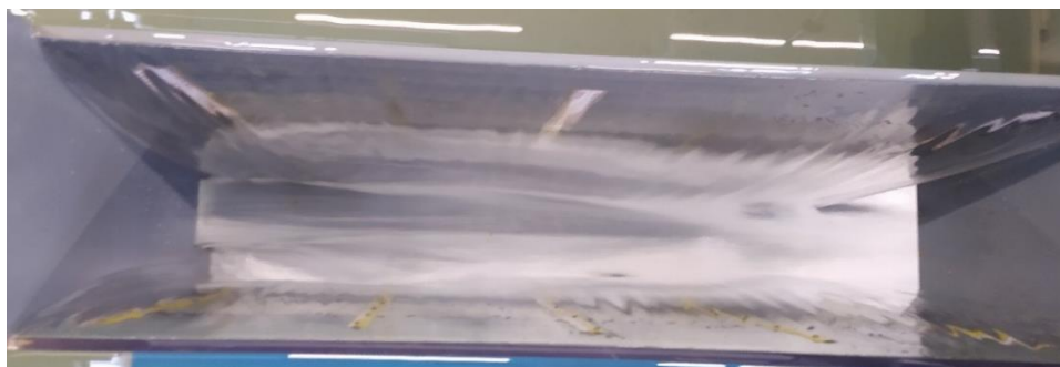
Obr. 88 – Pohled do spadiště (výška otevření výpusti 0,06 m) pro průtok 17,5 l/s – výpust i přeliv v provozu
