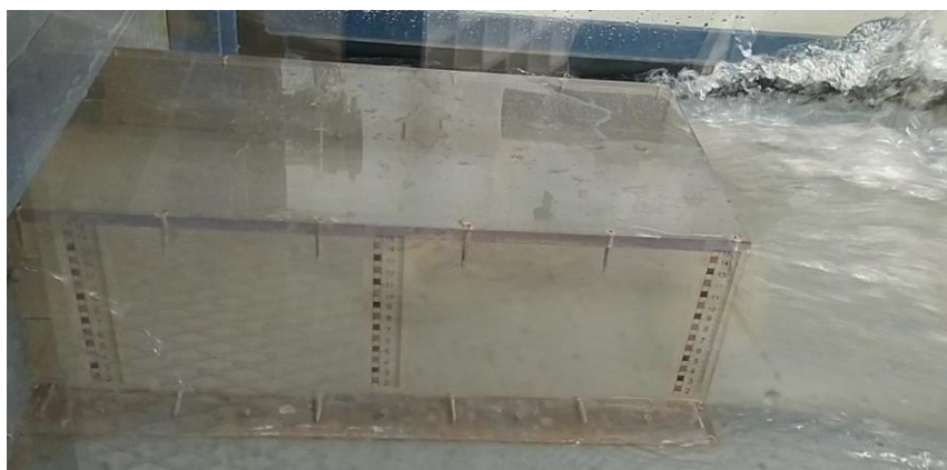
Obr. 86 – Pohled na odpadní objekt pro stav zatopeného přepadu (výška otevření 0,06 m)
