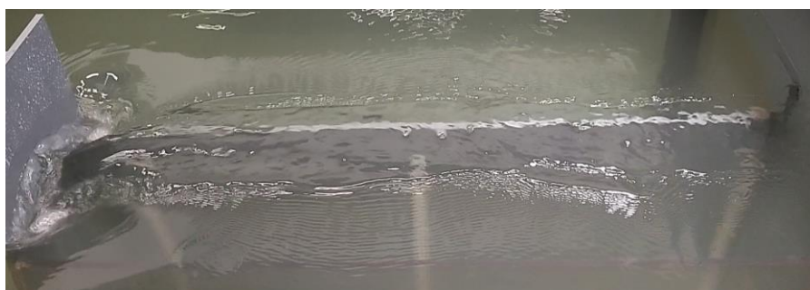
Obr. 70 – Pohled do spadiště pro průtok cca 112 l/s (zatopený přepad)
