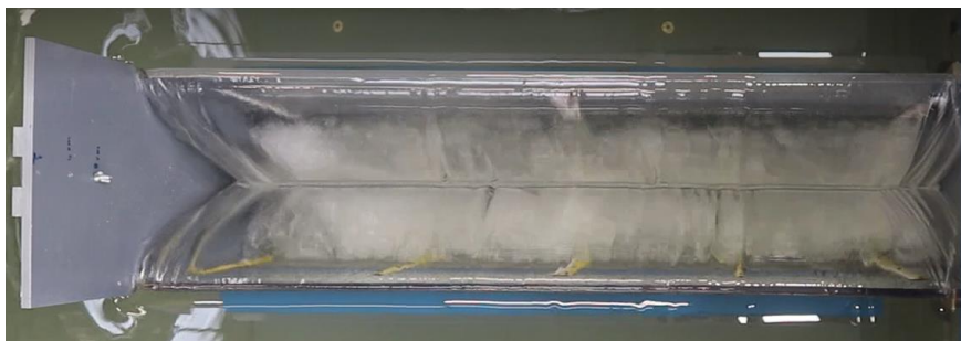
Obr. 67 – Pohled do spadiště pro průtok 25,5 l/s (autor Ing. T. Kašpar, Phd.)
