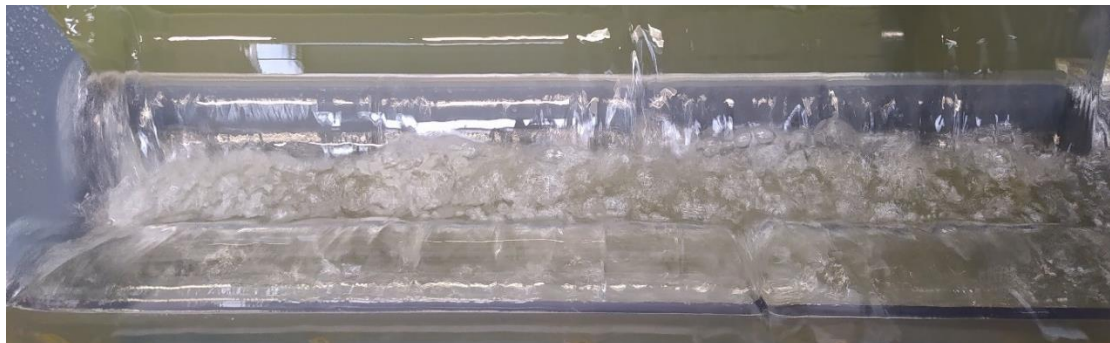
Obr. 91 – Pohled do spadiště (výška otevření výpusti 0,06 m) pro průtok 95,3 l/s – výpust i přeliv v provozu
