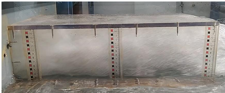
Obr. 85 – Pohled na odpadní objekt ze strany (výška otevření výpusti 0,06 m) pro průtok 40,7 l/s – tlakový režim proudění, výpust i přeliv v provozu
