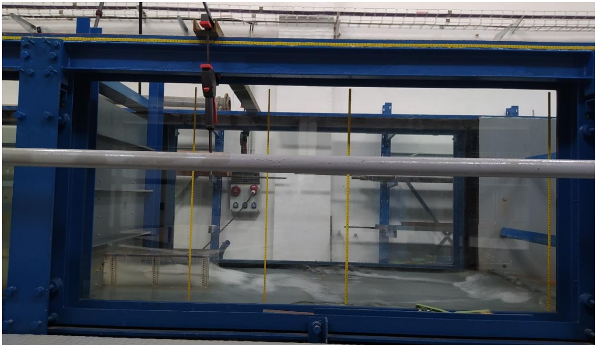
Obr. 46 – Pohled na laboratorní žlab za fyzikálním modelem, na část fyzikálního modelu (odpadní chodba), na měřidla (měřící metr) na skle a na odtok ze žlabu
