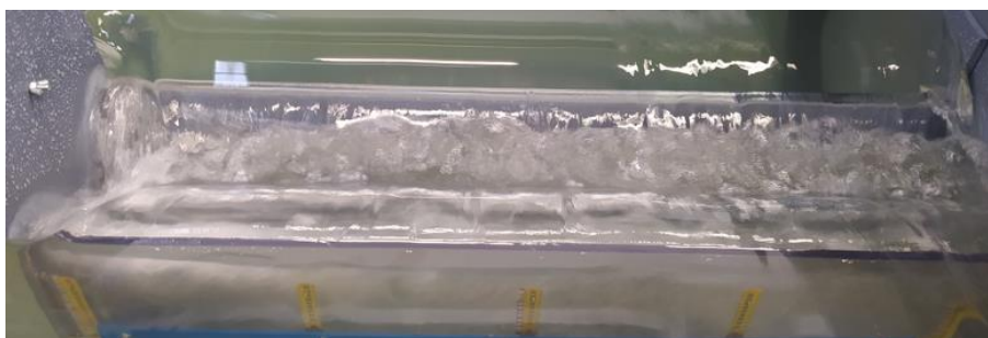
Obr. 69 – Pohled do spadiště pro průtok cca 95 l/s
