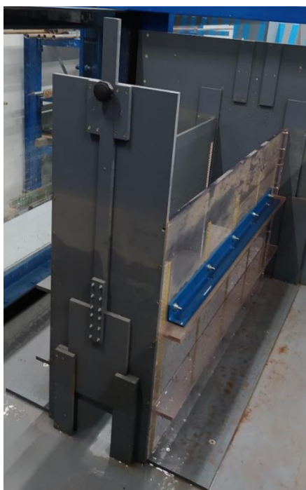
Obr. 49 – Fyzikální model zepředu (výpust, stavidlo a bezpečnostní přeliv)
