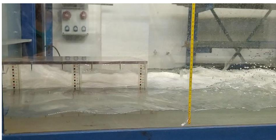
Obr. 98 – Pohled na výtok z odpadu pro průtok 32,1 l/s pro dolní okrajovou podmínku y = 0,07 m (výška otevření výpusti 0,1 m) - výpust i přeliv v provozu
