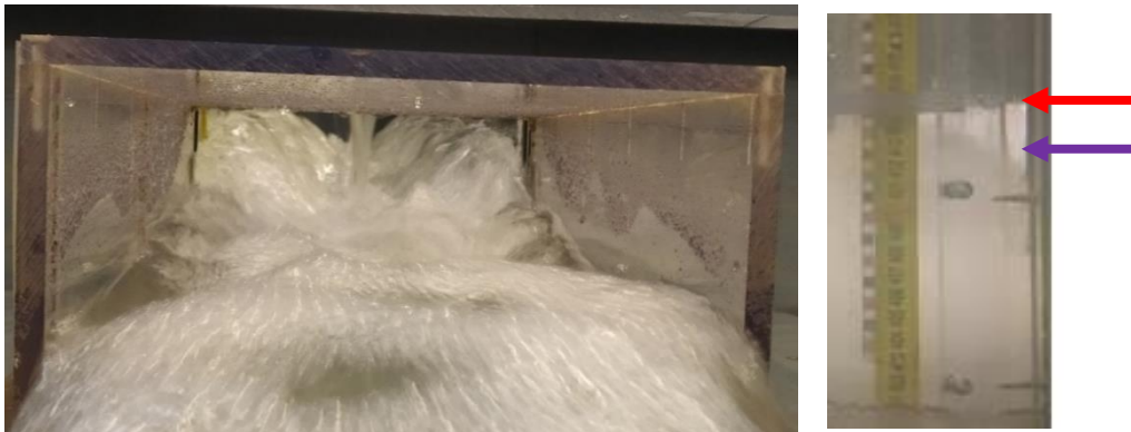
Obr. 57 – Pohled odpadním objektem směrem do spadiště pro průtok 12,0 l/s
