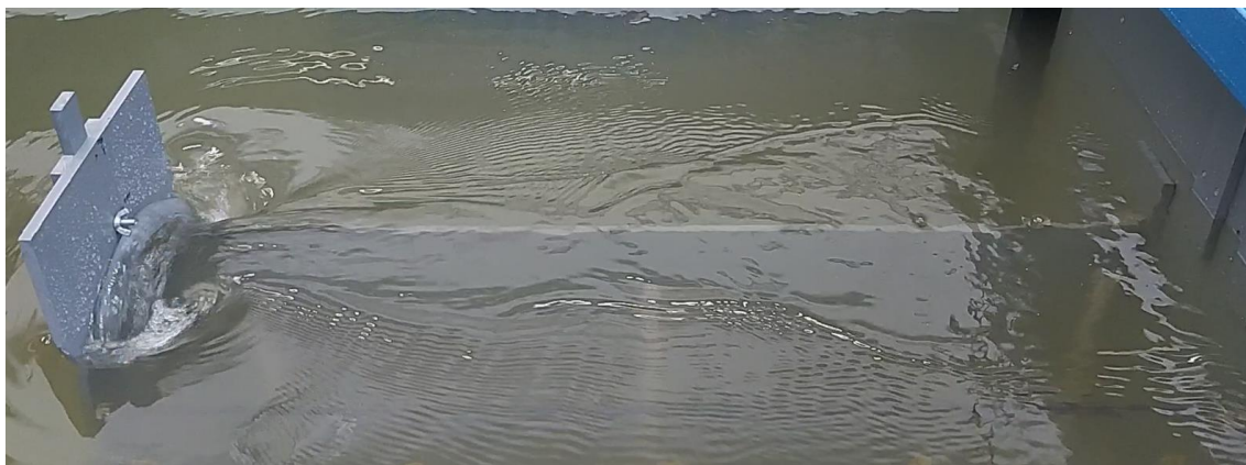
Ob. 92 – Pohled do spadiště pro zahlcený přeřad (výška otevření výpusti 0,06 m)
