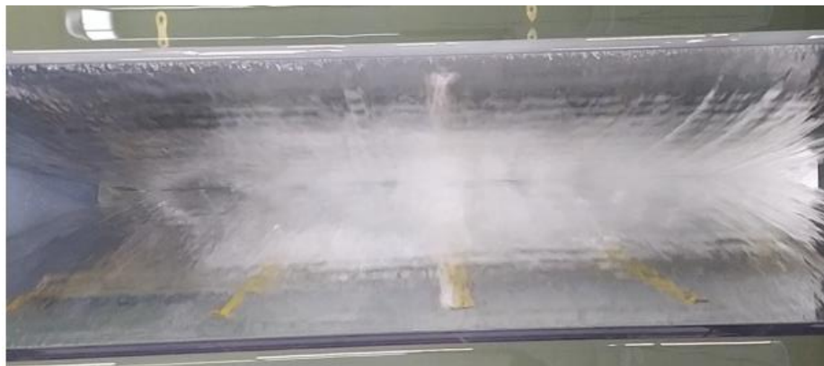
Obr. 89 – Pohled do spadiště s (výška otevření výpusti 0,06 m) pro průtok 25,5 l/ – výpust i přeliv v provozu
