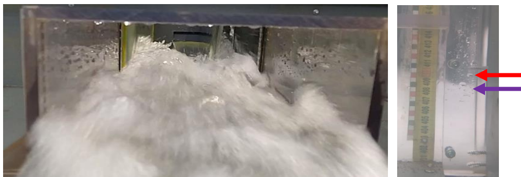
Obr. 79 – Pohled odpadním objektem směrem do spadiště (otevření výpusti 0,06 \text{ m} ) pro průtok 17,5 \text{ l/s} – výpust i přeliv v provozu
