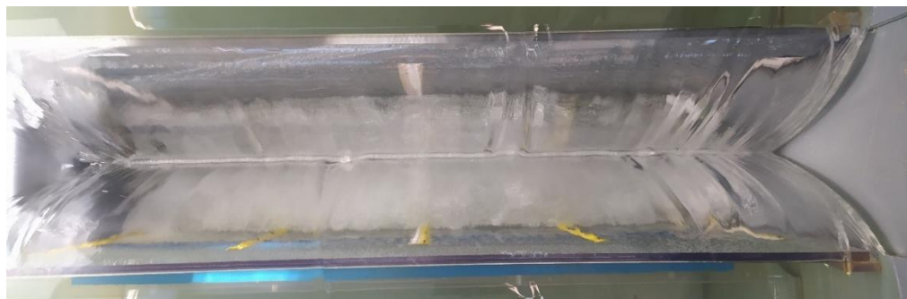
Obr. 90 – Pohled do spadiště (výška otevření výpusti 0,06 m) pro průtok 40,7 l/s – výpust i přeliv v provozu
