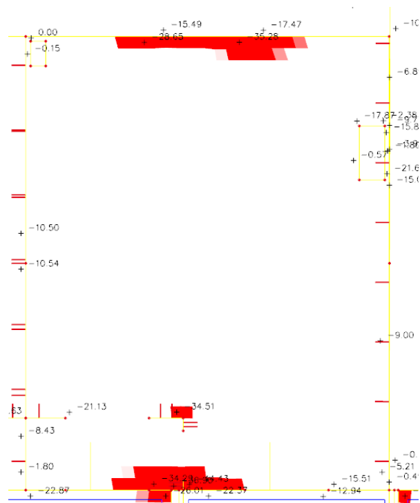
Obrázek 4.1.8 – Maximální moment u horních vláken ve směru osy y [kNm/m], který převyšuje únosnost základní výztuže
