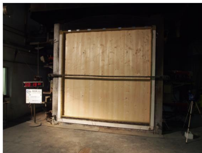
Obrázek 12. – Panel po 19. minutách zkoušky [7]
