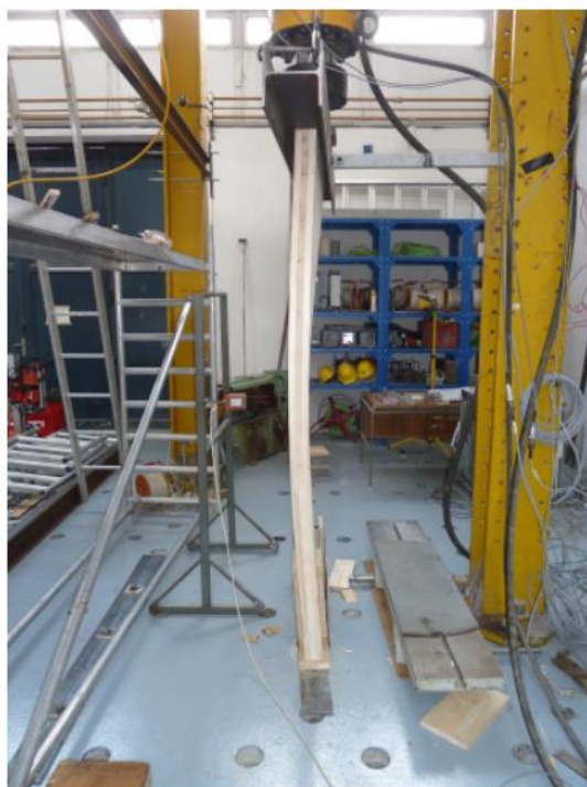
Obrázek 17. – dosažení max. zatížení při tlaku 5,12 tuny [7]
