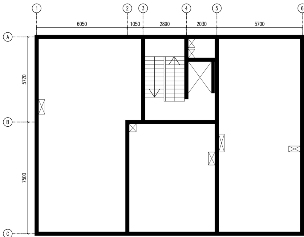
Obr. 2 Konstrukční systém 1.PP
