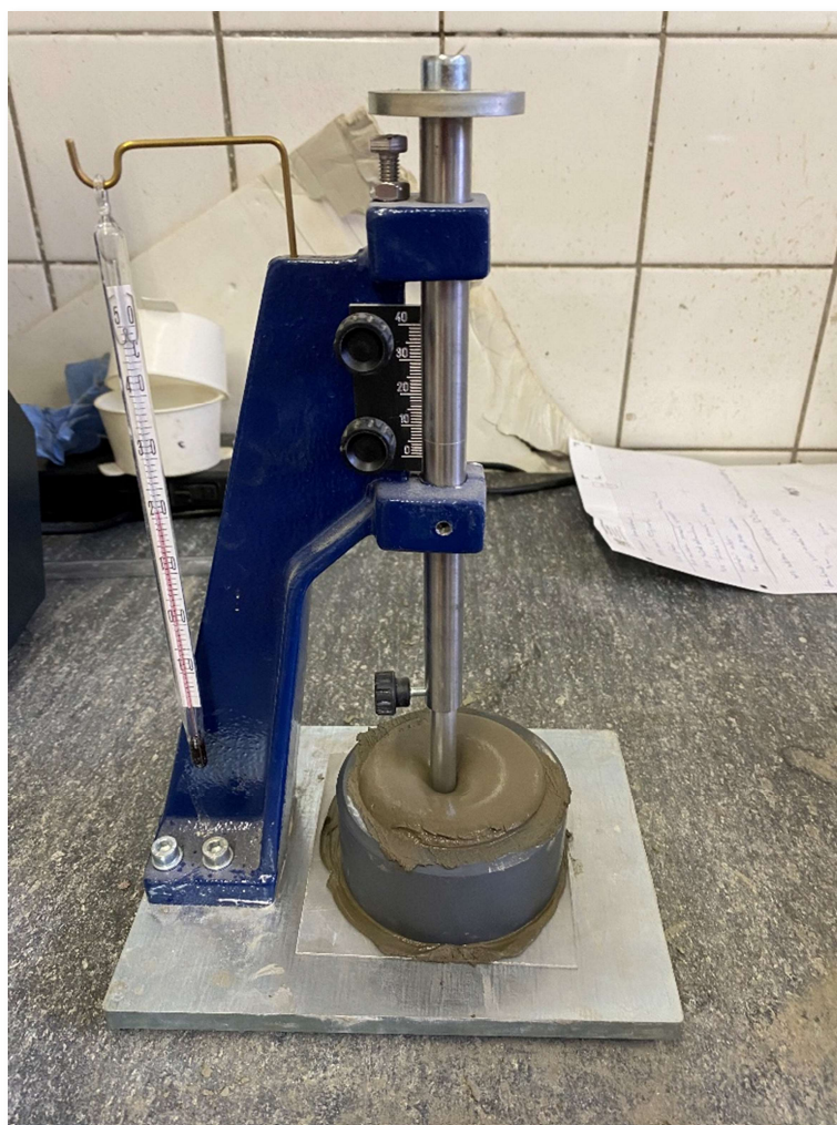
Obrázek 10 - Stanovení normální konzistence pomocí ručního Vicatova přístroje
