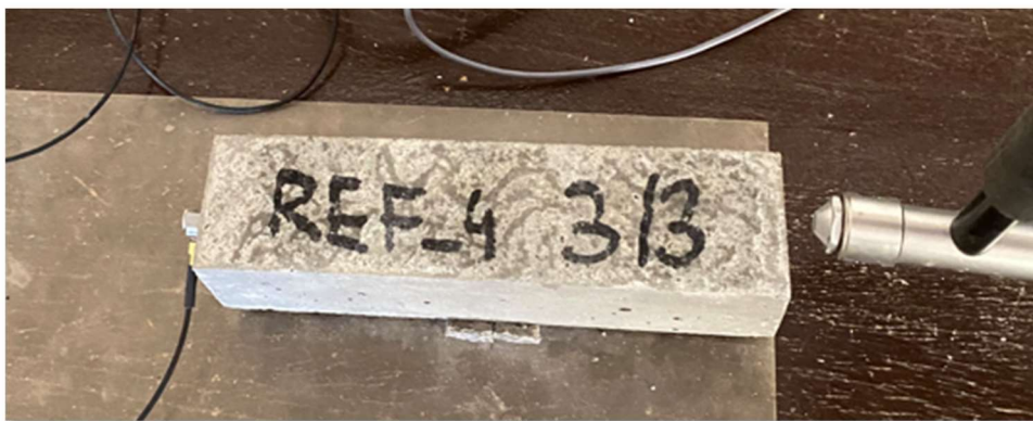
Obrázek 14 – Poloha snímače a rázového kladívka při měření podélného kmitání
