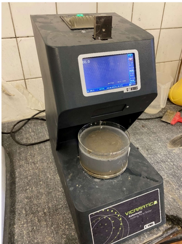
Obrázek 11 - Stanovení doby tuhnutí pomocí automatického Vicatova přístroje
