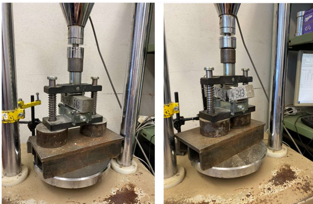
Obrázek 17 - Zkouška pevnosti v tahu za ohybu
