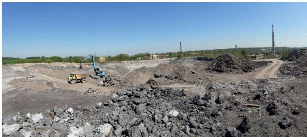
Obrázek 19 - Odtěžování strusky z haldy Koněv
