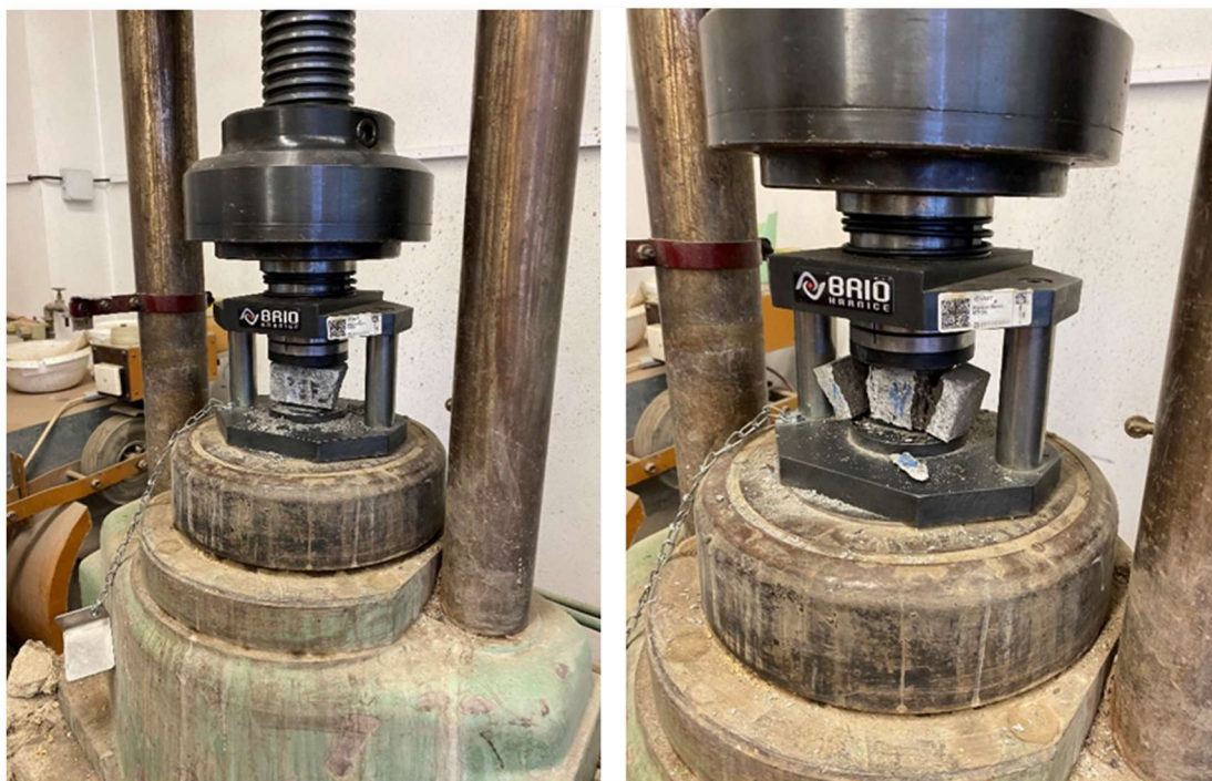
Obrázek 18 – Zkouška pevnosti v tlaku
