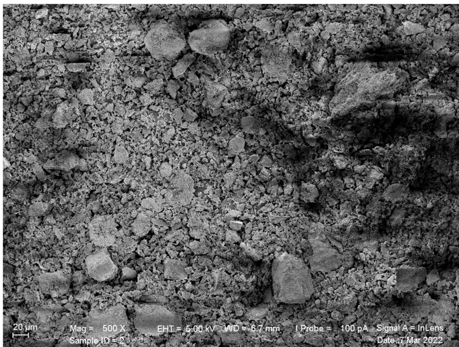
Obrázek 21 - Snímek SEM (fluidní popílek a vysokopecní struska Kladno 50:50), zvětšeno 500×, detektor sekundárních elektronů
