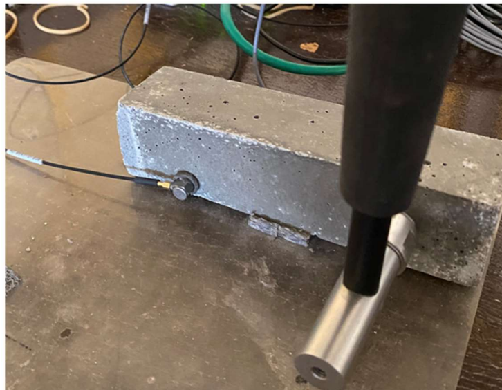
Obrázek 16 - Poloha snímače a rázového kladívka při měření kroutivého kmitání
