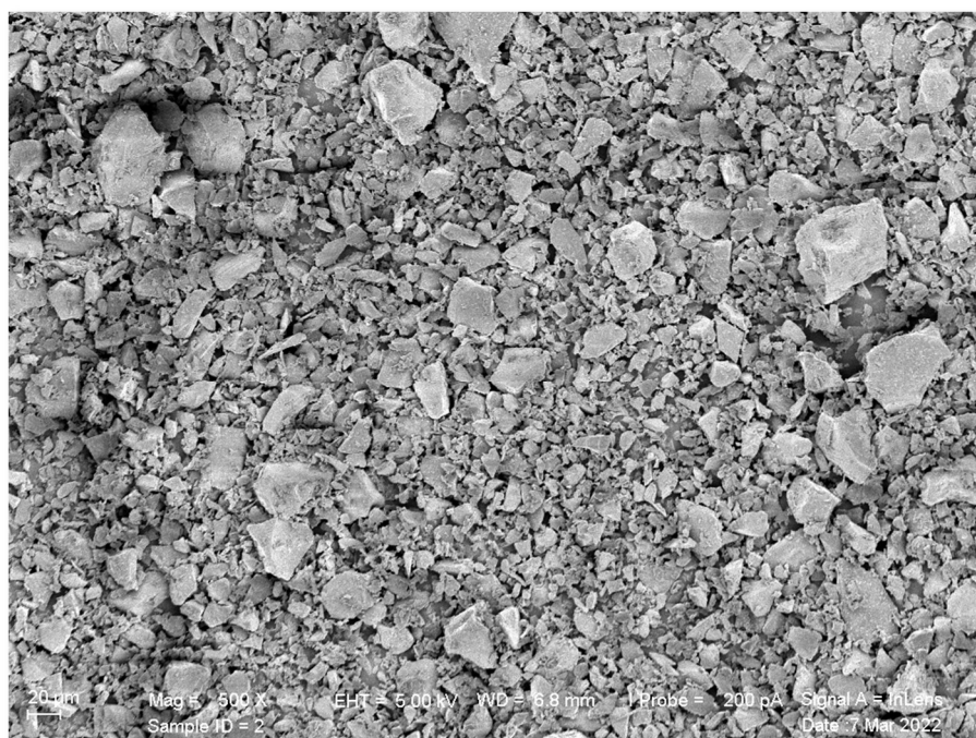
Obrázek 24 - Snímek SEM (vysokopecní struska EcoCoal), zvětšeno 500×, detektor sekundárních elektronů
