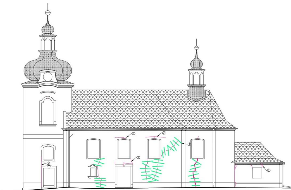
Obr. 126 Jihozápadní pohled – stehování
