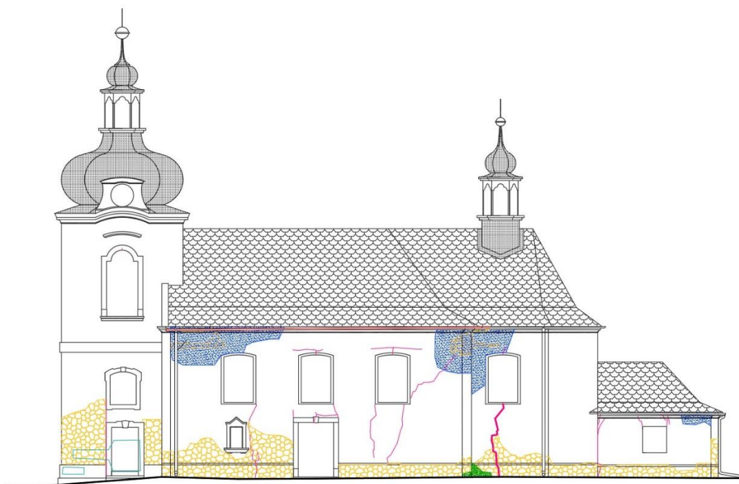
Obr. 35 Jihozápadní pohled s vyznačenými poruchami
