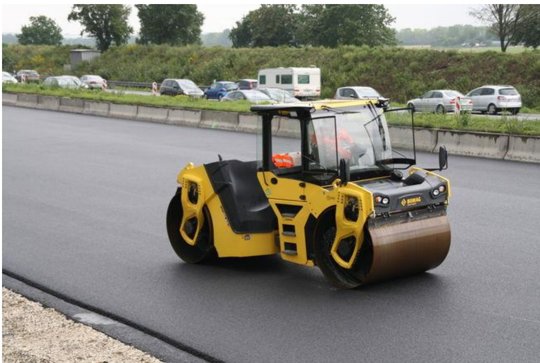
Obrázek 4 - Dvousý tandemový válec Bomag BW 206 AD - 5 s vyosenými běhouny [10]
