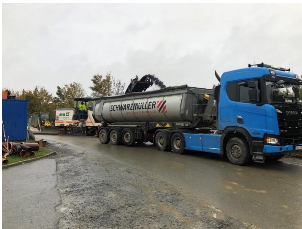
Obrázek 23 - Termoizolovaný návěs pro přepravu asfaltových směsí [zdroj vlastní]
