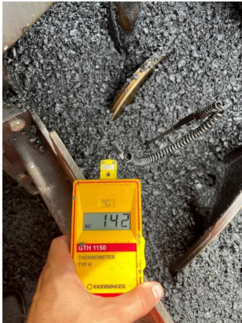
Obrázek 22 - Způsob měření teploty asfaltové směsi [zdroj vlastní]
