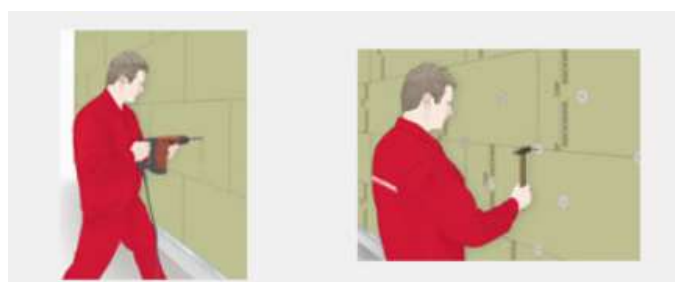
Obrázek 96, kotvení desek z kamenné vlny (14)
