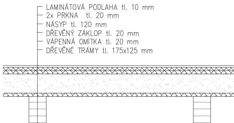
Obrázek 7, skladba trámové stropní konstrukce
