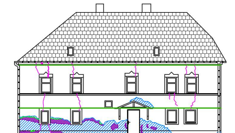
Obrázek 51, jihovýchodní pohled s předpínacími táhly
