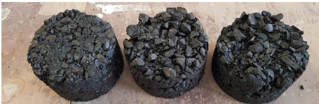
Obr. 20 - Zkušební tělesa před kartáčováním ponořena do petroleje JET A-1 (zleva těleso hutněné skupiny I., II., III.) [4]
