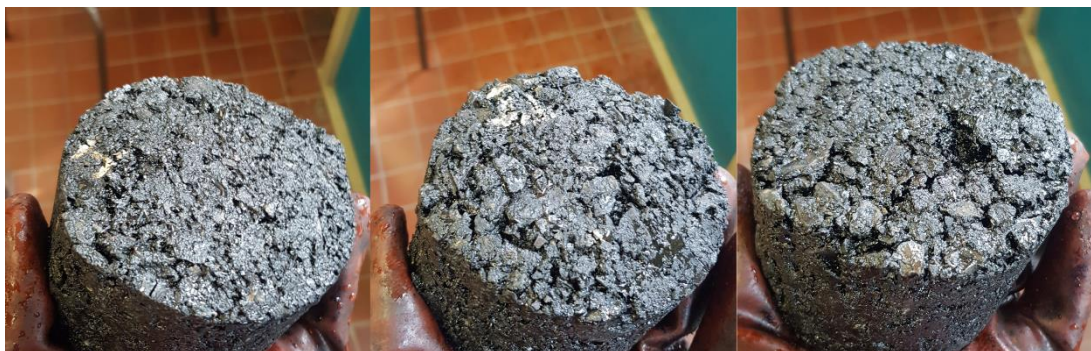
Obr. 26 - Zkušební tělesa namáhaná petrolejem JET A-1 po stlačení čelistí (zleva těleso hutněné skupiny I., II., III.) [4]
