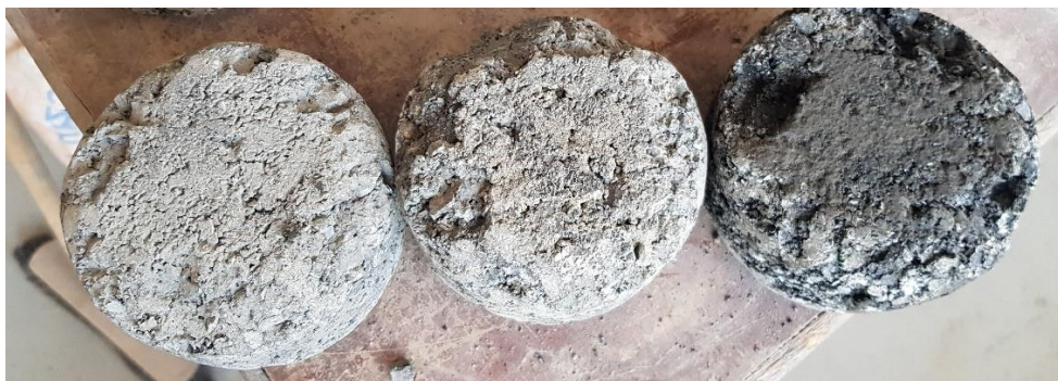
Obr. 28 - Otlučená referenční tělesa (zleva těleso hutněné skupiny I., II., III.) [4]
