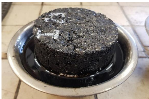
Obr. 10 - Těleso ponořené v palivu [4]
