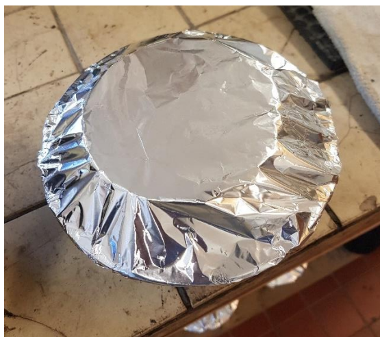
Obr. 35 - Těleso přikryté kovovou fólií [4]
