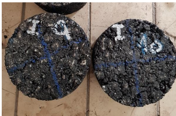
Obr. 6 - Číselné značení těles se znázorněnými osami pro měření rozměrů [4]
