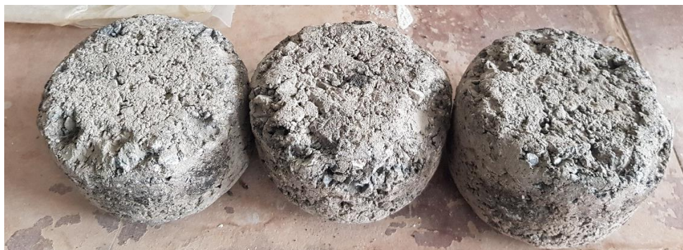
Obr. 29 - Otlučená zkušební tělesa namáhaná benzínem AVGAS 100LL (zleva těleso hutněné skupiny I., II., III.) [4]
