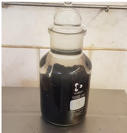
Obr. 9 - Naplněný pyknometr rozdrobenou směsí a demineralizovanou vodou [4]
