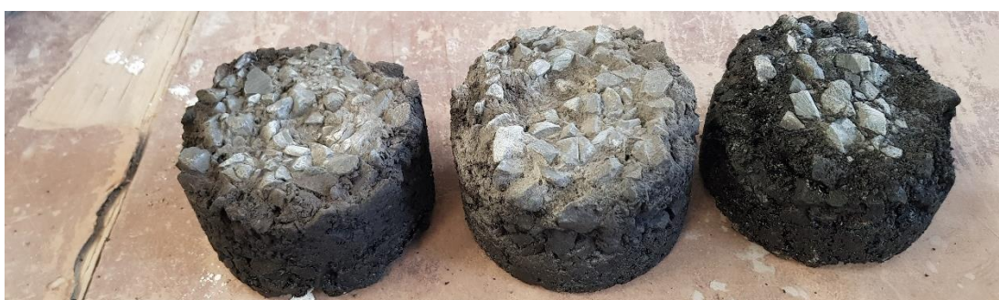
Obr. 19 - Zkušební tělesa po kartáčování ponořena do benzínu AVGAS 100LL (zleva těleso hutněné skupiny I., II., III.) [4]
