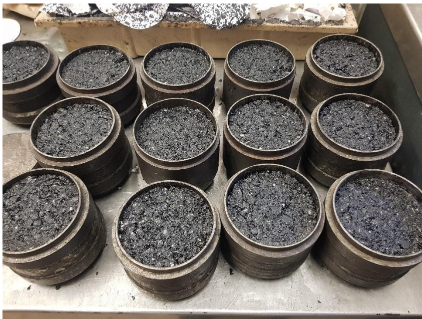
Obr. 34 - Zhutněná zkušební tělesa ve válcových formách odstavena k ochladnutí [4]
