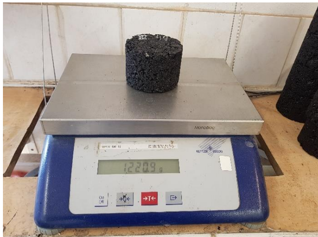
Obr. 7 - Vážení zkušebního tělesa [4]
