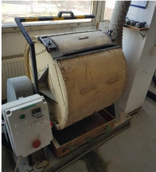
Obr. 13 - Rotační otlukový buben Los Angeles [4]
