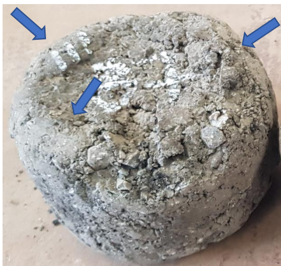
Obr. 32 - Viditelné tvoření vln na kraji zkušebního tělesa nejméně hutněné skupiny [4]
