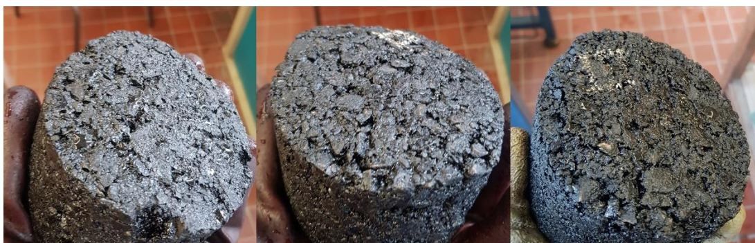
Obr. 27 - Zkušební tělesa namáhaná petrolejem JP/F-34 po stlačení čelistí (zleva těleso hutněné skupiny I., II., III.) [4]
