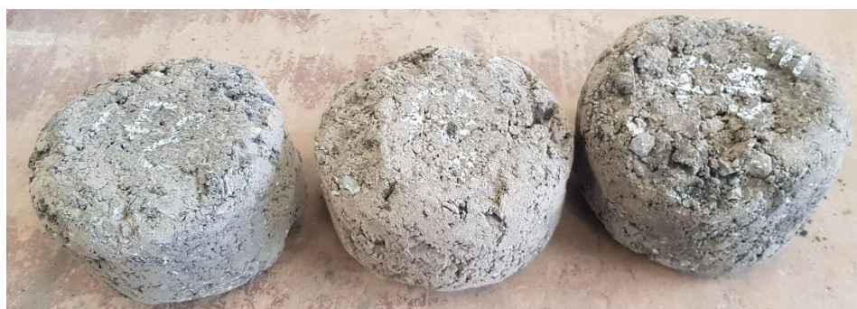
Obr. 30 - Otlučená zkušební tělesa namáhaná petrolejem JET A-1 (zleva těleso hutněné skupiny I., II., III.) [4]
