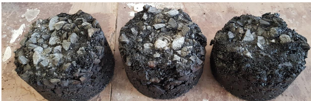
Obr. 21 - Zkušební tělesa po kartáčování ponořena do petroleje JET A-1 (zleva těleso hutněné skupiny I., II., III.) [4]
