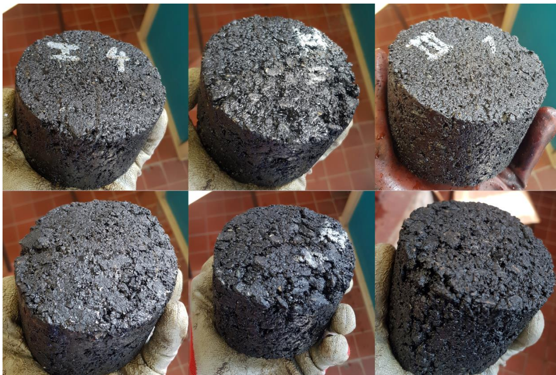
Obr. 25 - Zkušební tělesa namáhaná benzínem AVGAS 100LL před a po stlačení čelistí (zleva těleso hutněné skupiny I., II., III.) [4]
