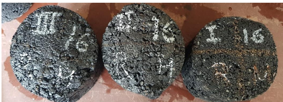
Obr. 24 - Referenční tělesa po stlačení čelistí (zprava těleso hutněné skupiny I., II., III.) [4]
