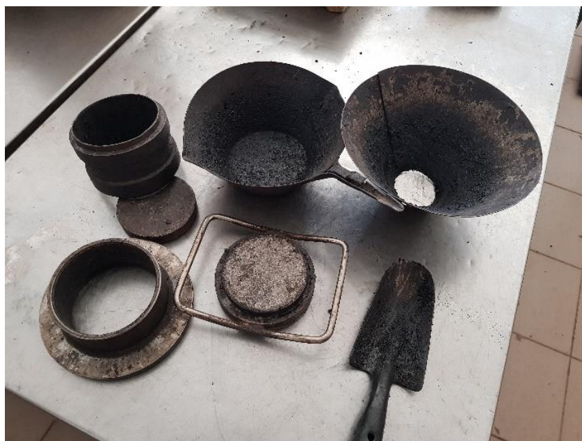
Obr. 33 - Pomůcky pro výrobu zk. těles (zleva: válcová forma, podložka, nástavec, fenek, podložka pro hutnění, násypka) [4]
