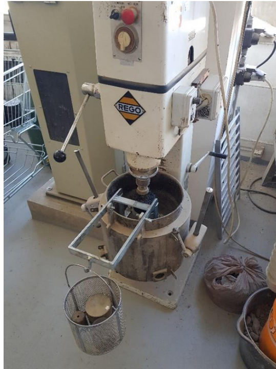
Obr. 11 - Laboratorní míchačka upravená ke kartáčování těles [4]
