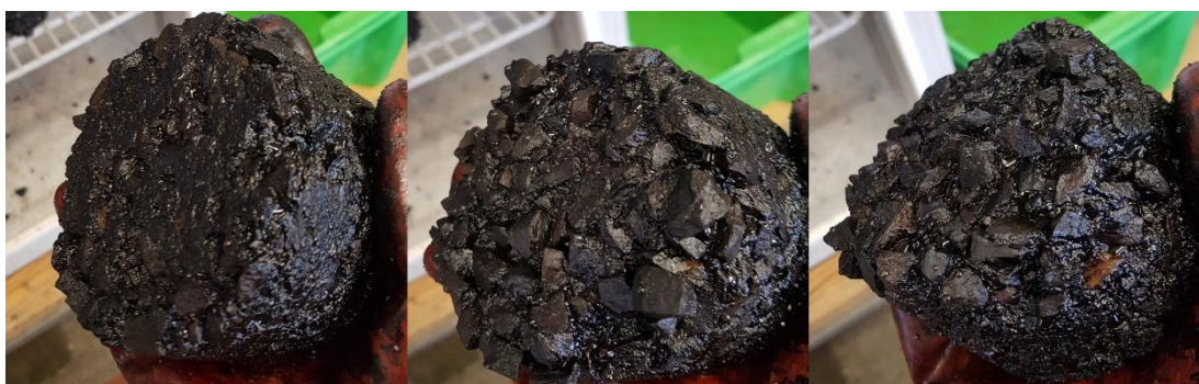
Obr. 15 - Změna tvaru zkušebního tělesa po ponoření do JET A-1 (zleva těleso hutněné skupiny I., II., III.) [4]
