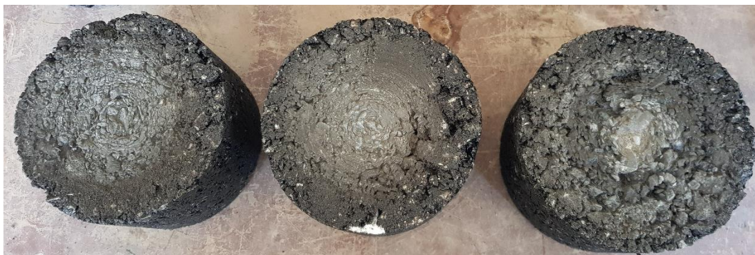
Obr. 17 - Referenční tělesa po kartáčování (zleva těleso hutněné skupiny I., II., III.) [4]
