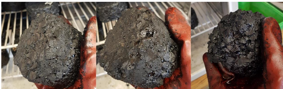
Obr. 14 - Změna tvaru zkušebního tělesa po ponoření do AVGAS 100 LL (zleva těleso hutněné skupiny I., II., III.) [4]
