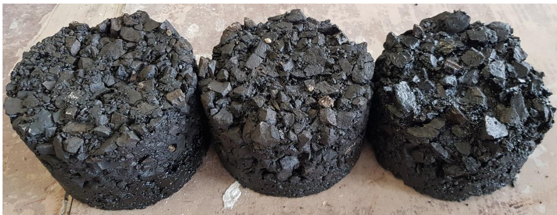
Obr. 22 - Zkušební tělesa před kartáčováním ponořena do petroleje JP/F-34 (zleva těleso hutněné skupiny I., II., III.) [4]
