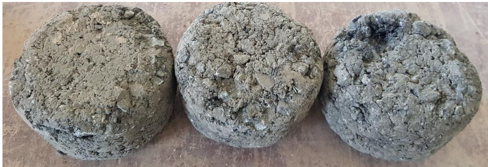
Obr. 31 - Otlučená zkušební tělesa namáhaná petrolejem JP/F-34 (zleva těleso hutněné skupiny I., II., III.) [4]
