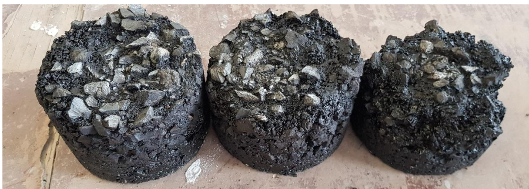
Obr. 23 - Zkušební tělesa po kartáčování ponořena do petroleje JP/F-34 (zleva těleso hutněné skupiny I., II., III.) [4]
