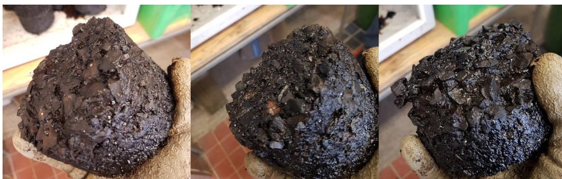
Obr. 16 - Změna tvaru zkušebního tělesa po ponoření do JP/F-34 (zleva těleso hutněné skupiny I., II., III.) [4]
