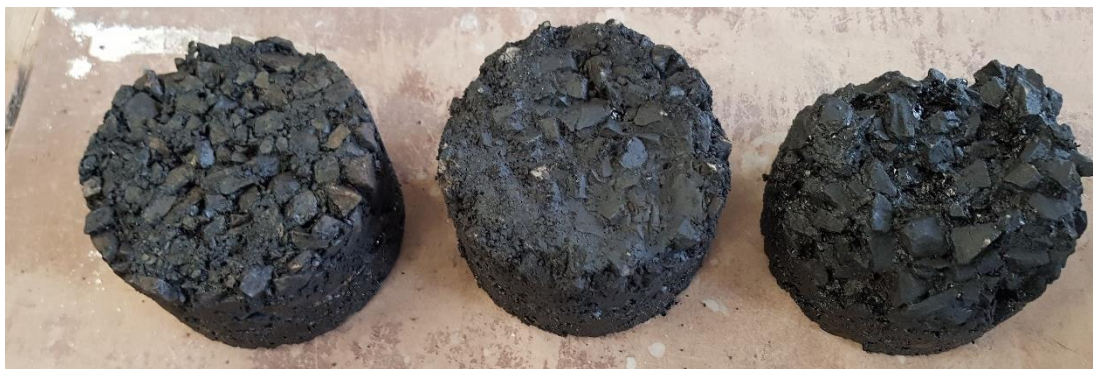
Obr. 18 - Zkušební tělesa před kartáčováním ponořena do benzínu AVGAS 100LL (zleva těleso hutněné skupiny I., II., III.) [4]
