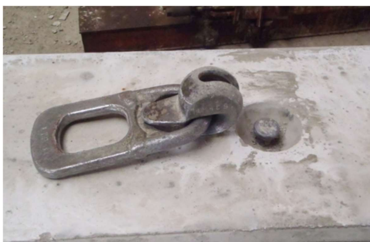
Obrázek 48- Finální podoba úchytu: trn s kulovou hlavou + zvedací oko [22]
