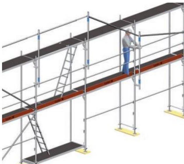
Obrázek 40- Montáž pomocného zábradlí
