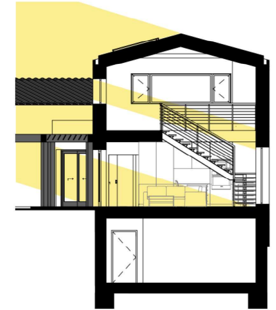
SCHÉMA OSLUNĚNÍ ZIMA 21.12. 12:00 - ÚHEL DOPADU 17°
