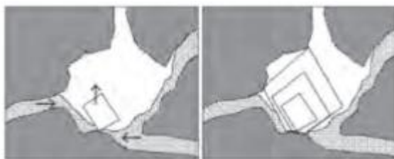
Obr. č. 4 - Schématické znázornění nárůstu krystalů soli v porézním systému (zdroj [2])
