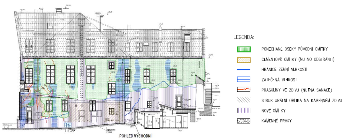
Obr. č. 21 - Pohledy - omítkové plochy I. (zdroj [Projektový ateliér pro architekturu a pozemní stavby])
