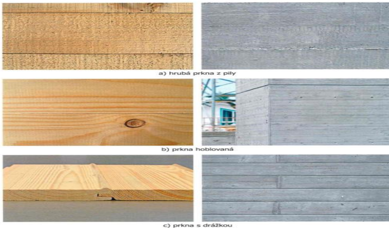
[Obr. 12 Pláště bednění a jejich otisky na povrchu betonu]
