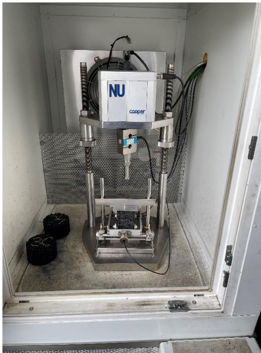
Obrázek 26 - Zkoušení vzorku metodou IT-CY [vlastní foto] (vlevo); popis zkušebního přístroje [27] (vpravo)
