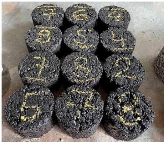
Obrázek 23 - Tělesa pro zkoušku ITSR [vlastní foto] (vlevo mokrá skupina), (vpravo suchá skupina)
