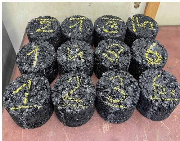
Obrázek 23 - Tělesa pro zkoušku ITSR [vlastní foto] (vlevo mokrá skupina), (vpravo suchá skupina)
