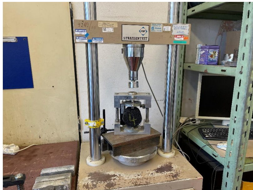
Obrázek 25 - Těleso upevněné v čelistích pro zkoušku ITSR
