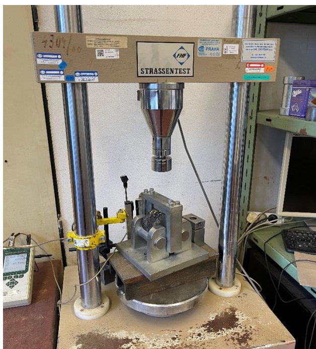
Obrázek 28 - Zkouška odolnosti vůči šíření trhlin na tělese [vlastní foto]
