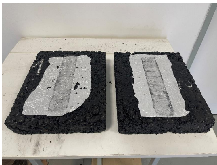
Obrázek 22 - ACP 16+ PMB 25/55–65 (čistá směs) po zkoušce poježdění kolem [vlastní foto]
