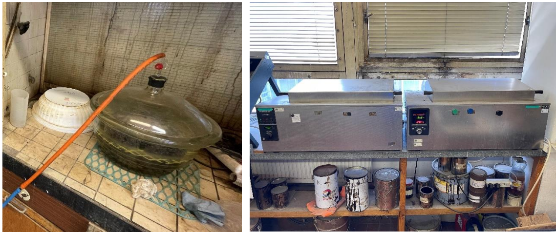
Obrázek 24 - Vakuová komora s vývěvou [vlastní foto] (vlevo); Vodní lázeň pro temperaci [vlastní foto] (vpravo)
